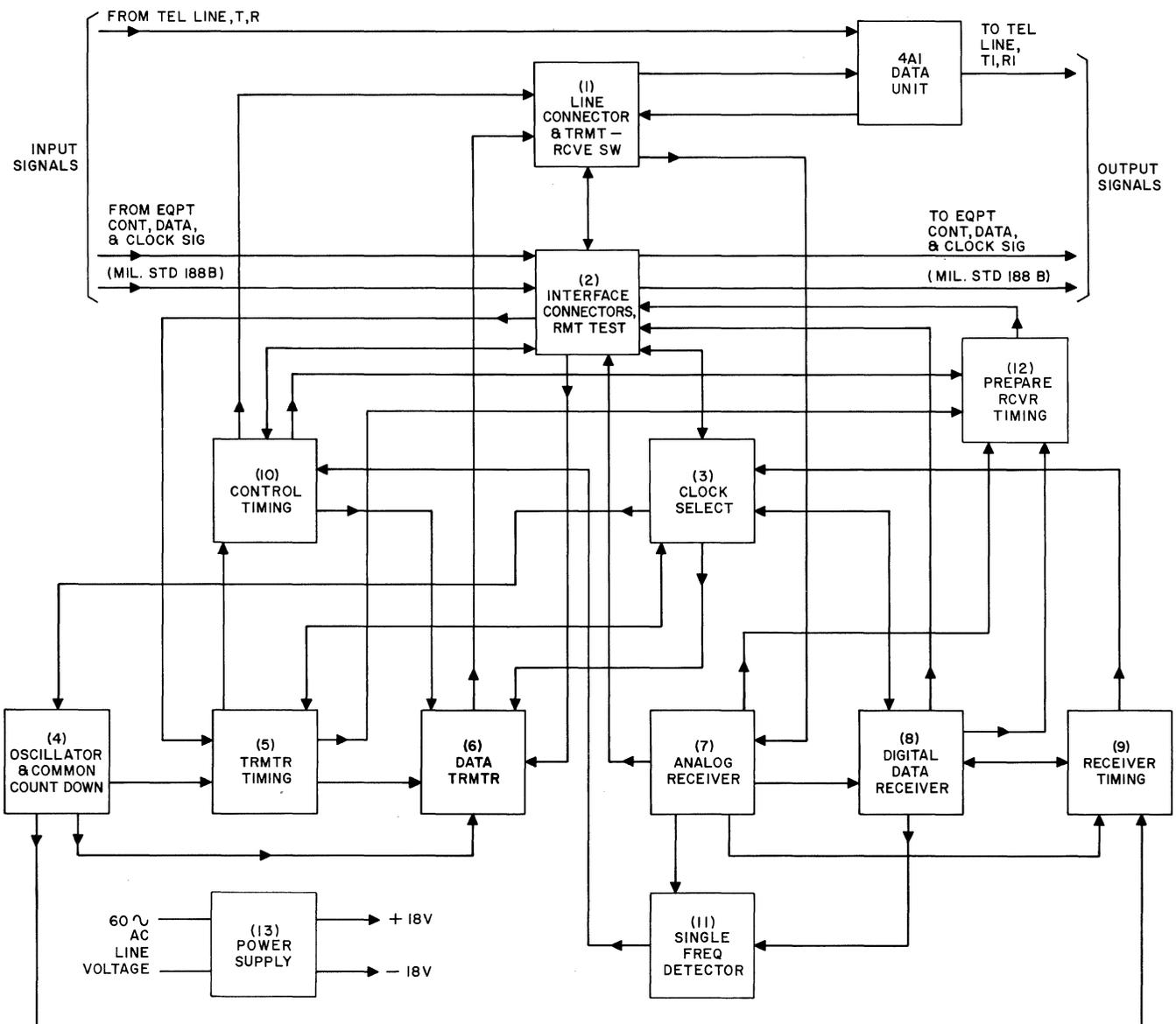
Fig. 3—Data Set 205C Block Diagram
