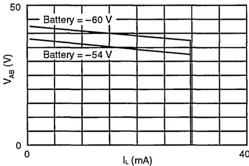
Figure 1a.  $V_{AB}$  vs  $I_L$
