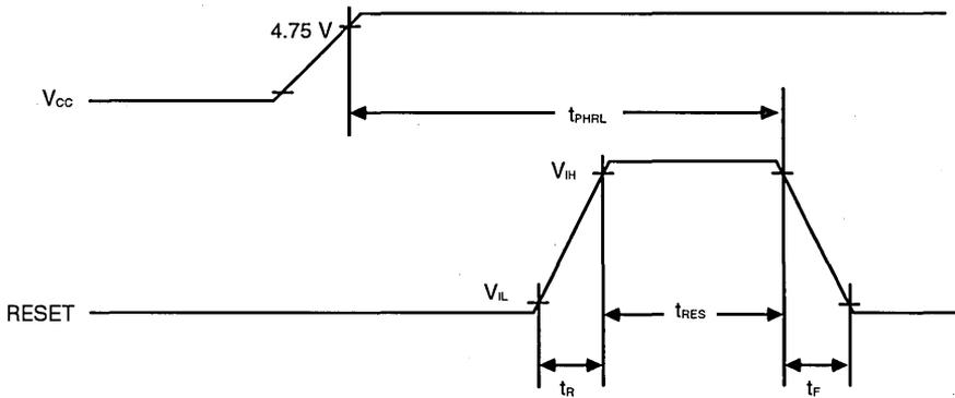
Figure 27. Reset Timing
