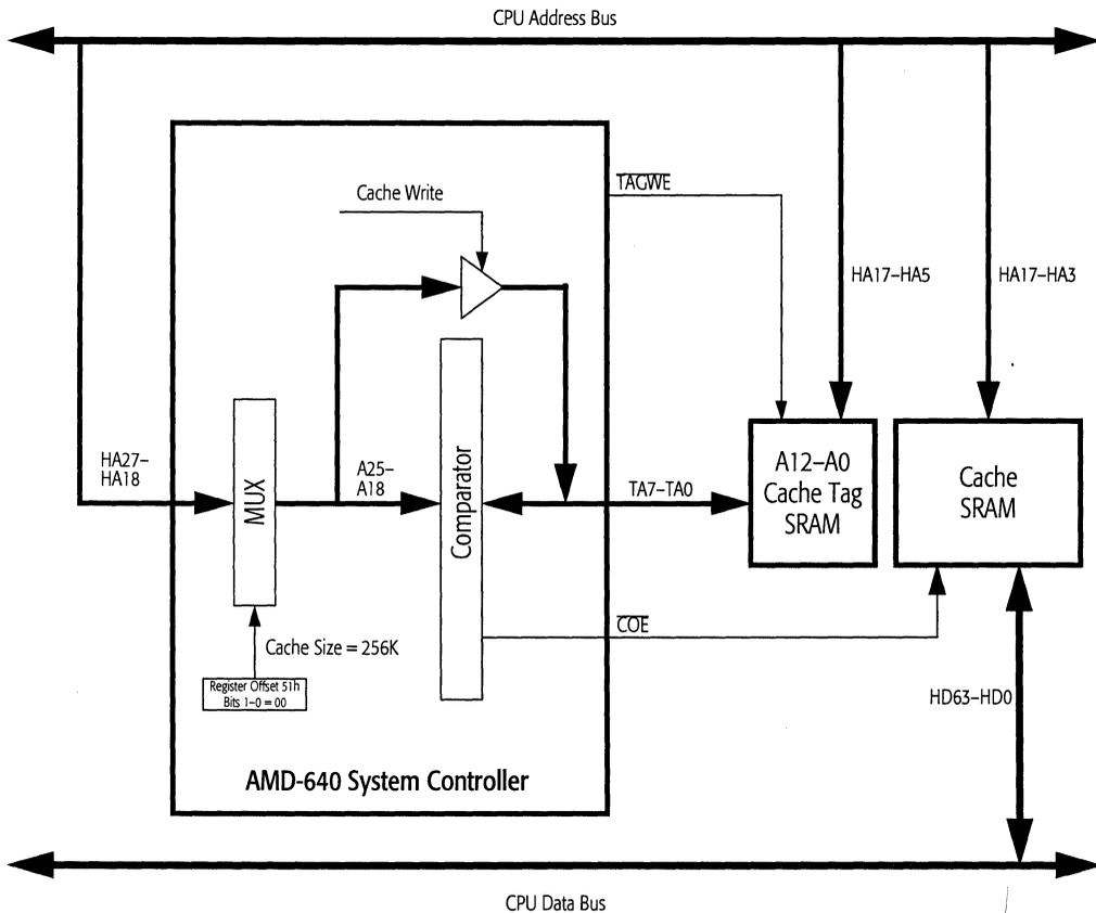
**Figure 5-3. 8-Bit Tag Cache Connections**
