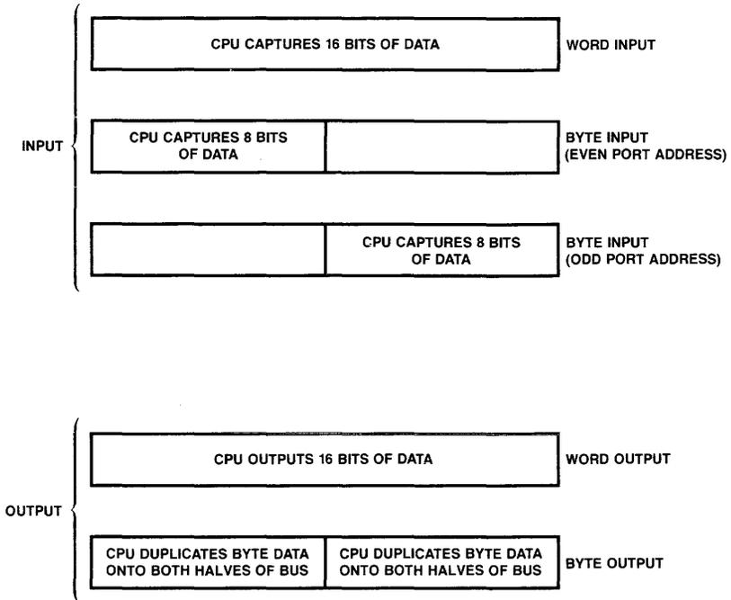
**Figure 3-4. Input/Output Data Formats.**
