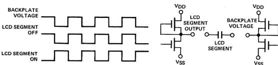
**FIG. 2 LCD OUTPUT DRIVE**
