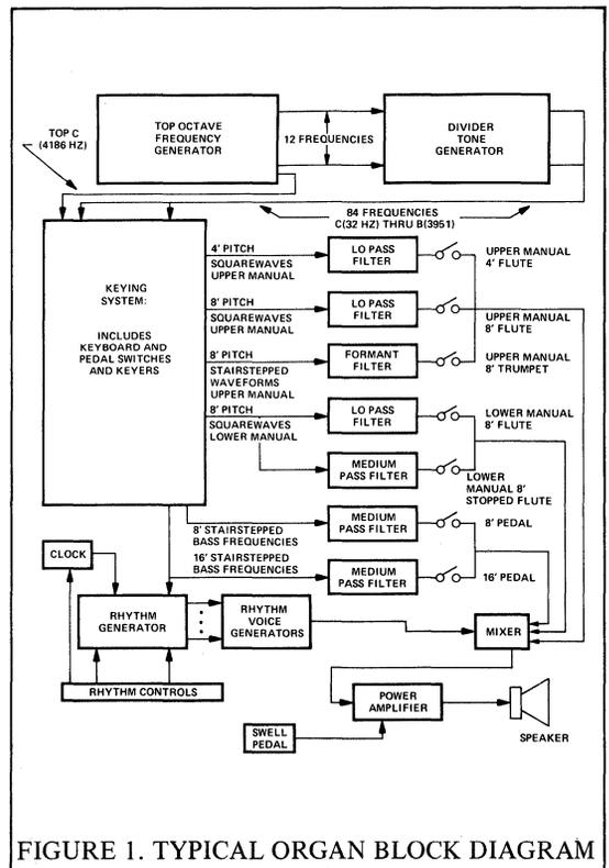
FIGURE 1. TYPICAL ORGAN BLOCK DIAGRAM
