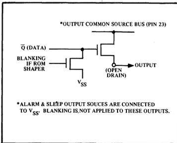
FIGURE 4. OUTPUT CIRCUITS
