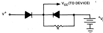
**FIGURE 2 STANDBY BATTERY CIRCUIT**
