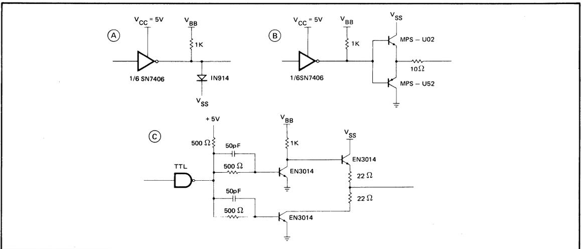
INTERFACE CIRCUITS – TYPICAL OUTPUT CHARACTERISTICS (25°C)
