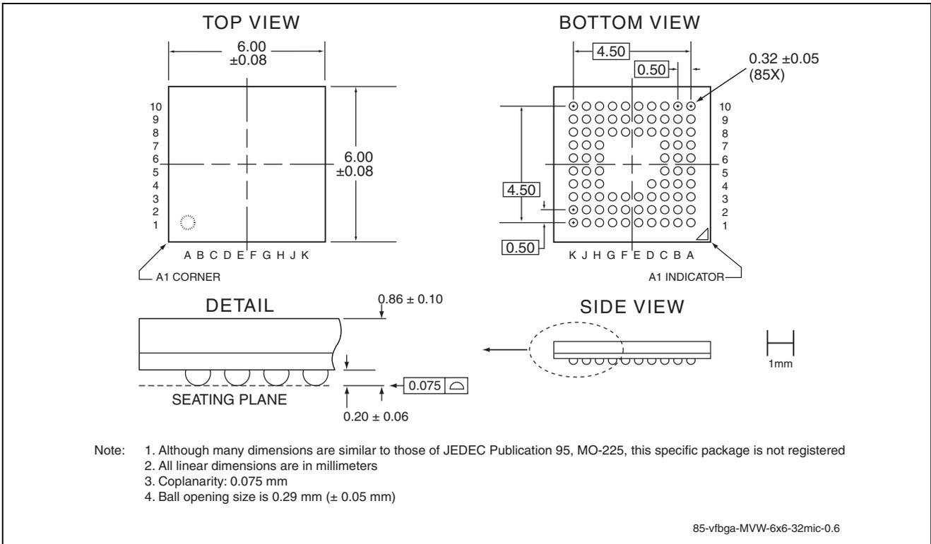
**FIGURE 15-2: 85-ball Very-Thin, Fine-Pitch, Ball Grid Array (VFBGA)**
