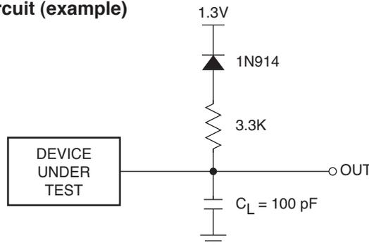
$C_L$  INCLUDES JIG CAPACITANCE
