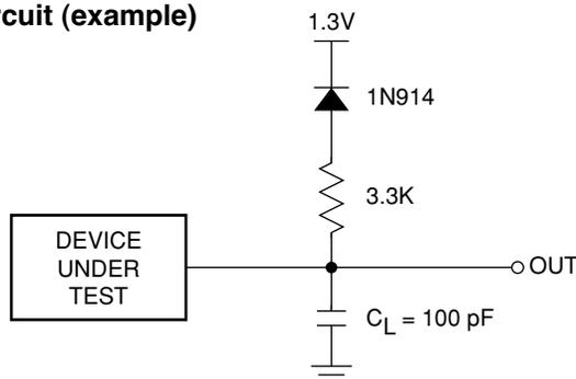
$C_L$  INCLUDES JIG CAPACITANCE
