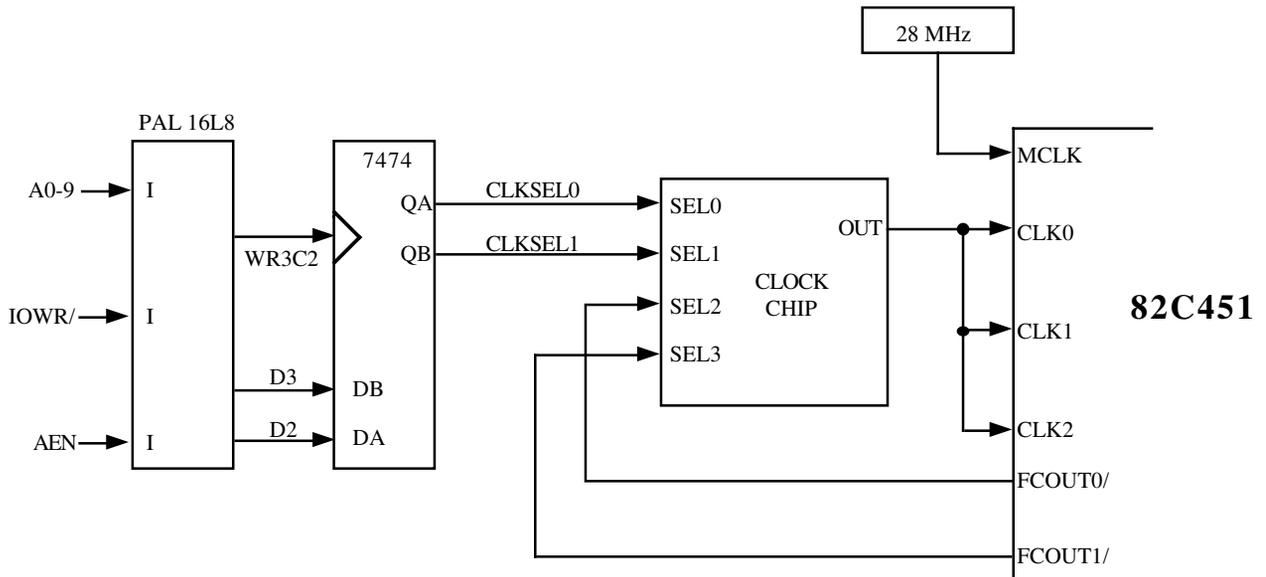
$$WR3C2 = \neg IOW \ \& \ \neg AEN \ \& \ A9 \ \& \ A8 \ \& \ A7 \ \& \ A6 \ \& \ \neg A5 \ \& \ \neg A4 \ \& \ \neg A3 \ \& \ \neg A2 \ \& \ A1 \ \& \ \neg A0$$
