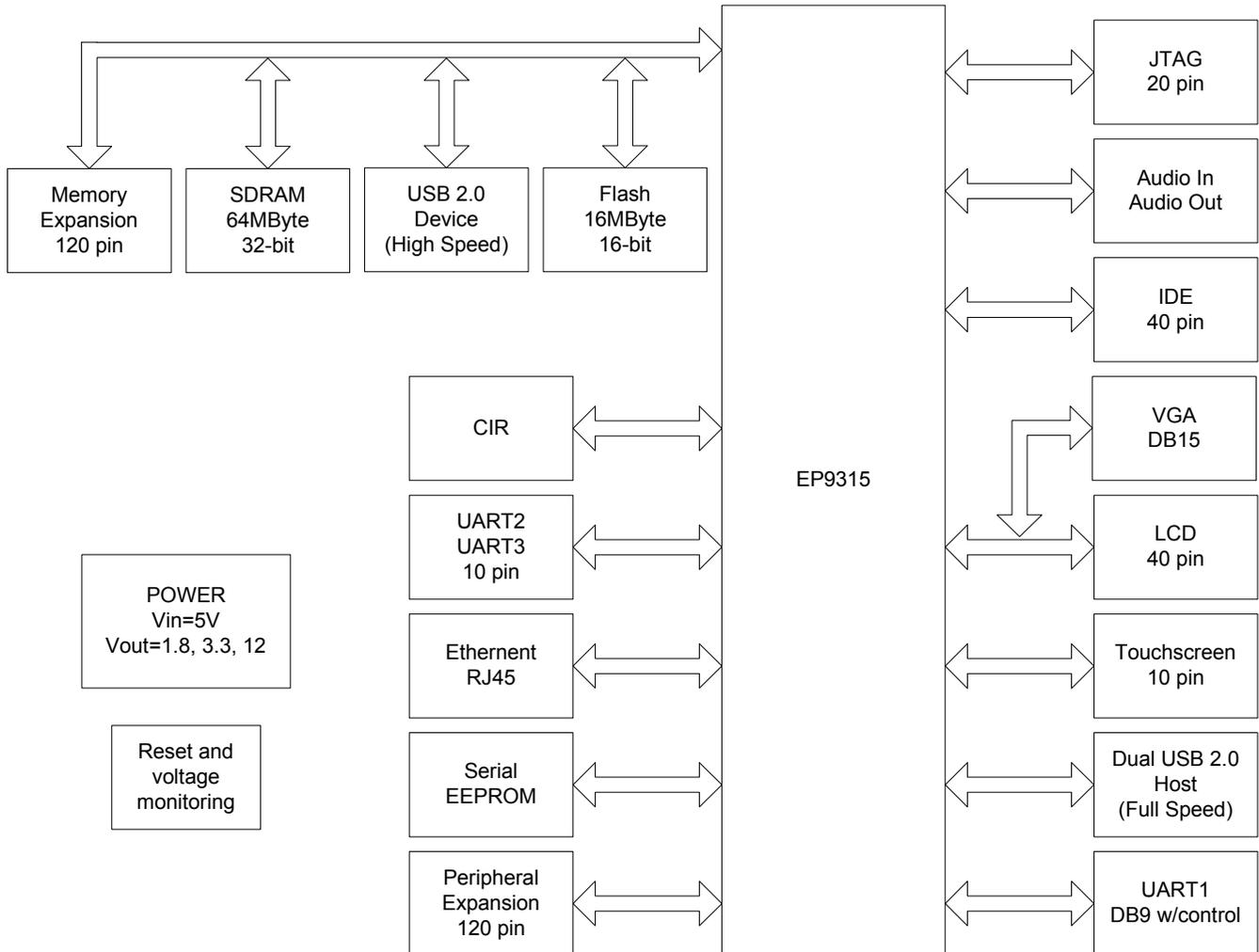
**Figure 3. Block Diagram**
