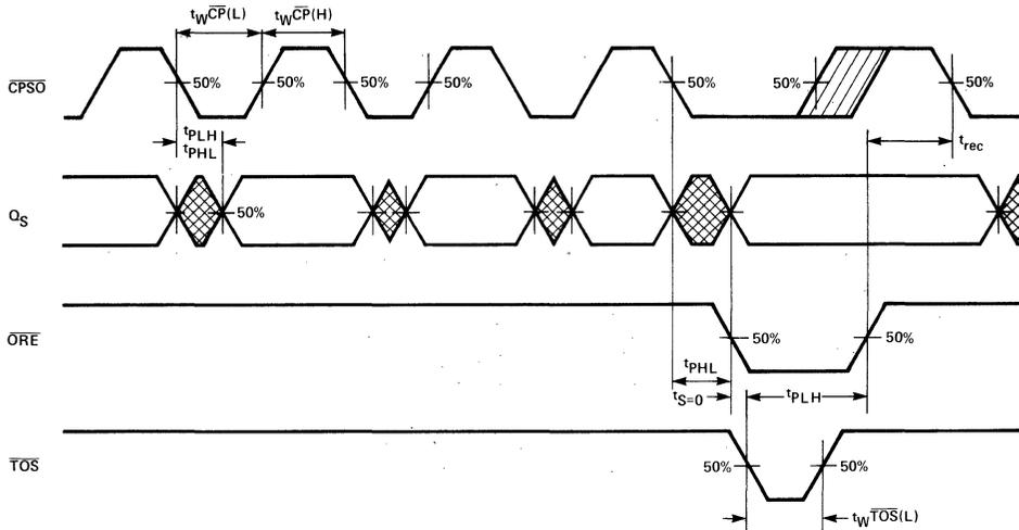
$\overline{OES}$  RECOVERY TIME, PROPAGATION DELAY  $\overline{CP\&S;O}$  TO  $Q\&S;$ ,  $\overline{CP\&S;O}$  TO  $\overline{OES}$ ,
