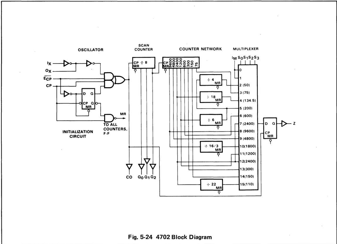
Fig. 5-24 4702 Block Diagram
