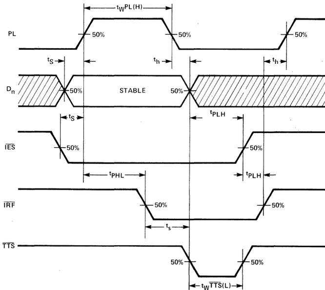
PROPAGATION DELAY,  $\overline{TTS}$  TO  $\overline{IES}$ ,  $\overline{IES}$  TO  $\overline{IRF}$ , PL TO  $\overline{IRF}$ .
