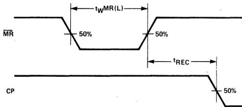
**MINIMUM  $\overline{MR}$  PULSE WIDTH AND  $\overline{MR}$  RECOVERY TIME**
