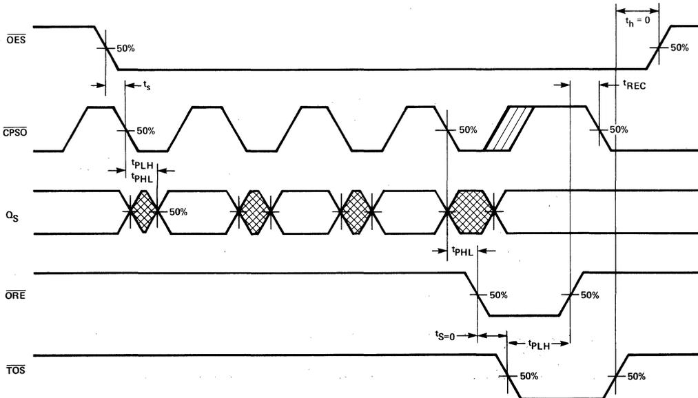
$\overline{OES}$  RECOVERY TIME, PROPAGATION DELAY  $\overline{CP\&S;O}$  TO  $Q\&S;$ ,  $\overline{CP\&S;O}$  TO  $\overline{OES}$ ,
