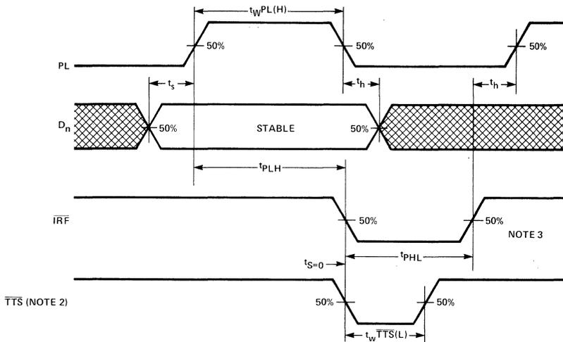
PROPAGATION DELAY PL TO  $\overline{IRF}$ ,  $\overline{TTS}$  TO  $\overline{IRF}$ .
