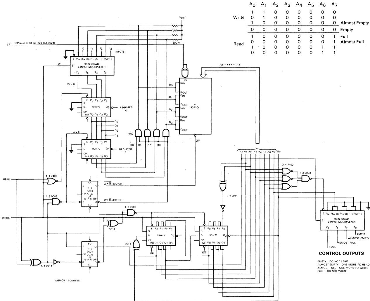
Fig. 5-5. LIFO Push-Down Stack Memory
