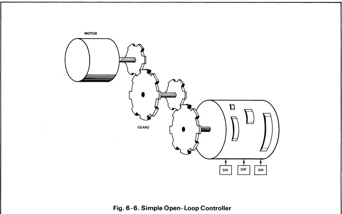
Fig. 6-6. Simple Open-Loop Controller
