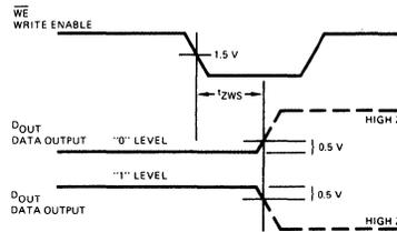
PROPAGATION DELAY FROM CHIP SELECT TO HIGH Z
