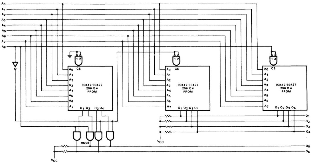
Fig. 6-12. 512 x 6-Bit Array
