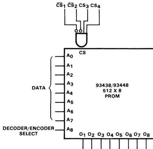
Fig. 6-4. Encoder/Decoder
