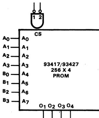
Fig. 6-2. 4-Bit Comparator
