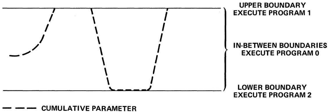
*Figure 12-8. Bang-Bang Control Logic*
