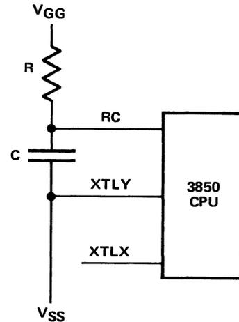
Figure 2-7. RC Mode Clock Generation
