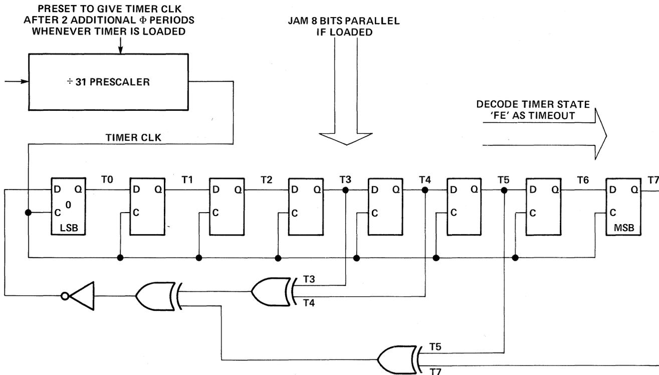
Figure 3-8. Timer Block Diagram
