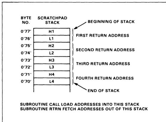
Fig. 7-3. Scratchpad Stack
