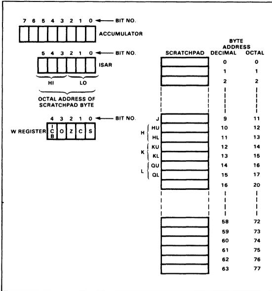
Fig. 2-8. 3850 CPU Programmable Registers
