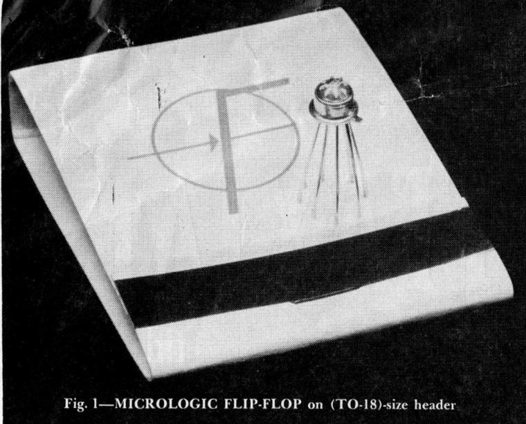
Fig. 1—MICROLOGIC FLIP-FLOP on (TO-18)-size header
