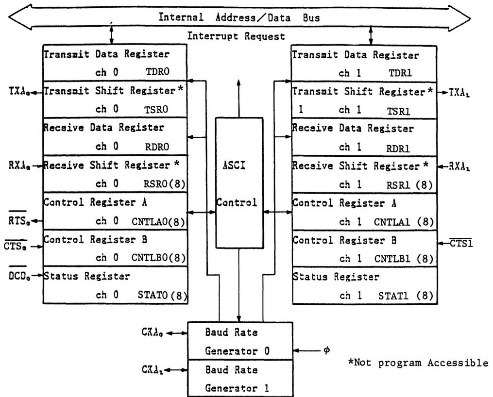
**Figure 2.10.1 ASCI Block Diagram**
