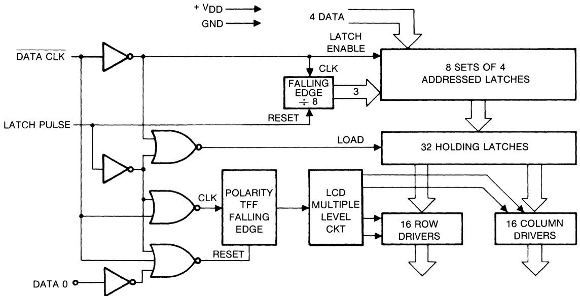
**TYPICAL SYSTEM BLOCK DIAGRAM USING 0488**
