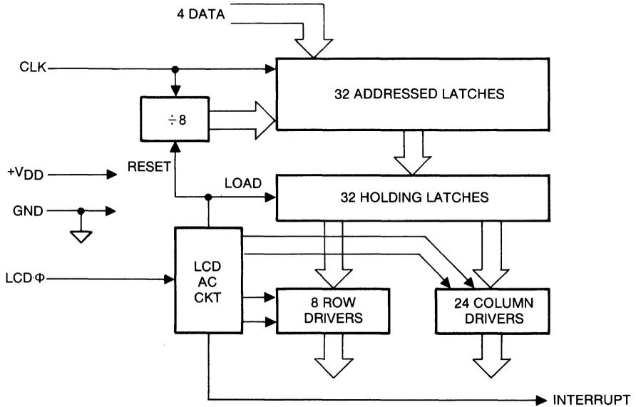
TYPICAL SYSTEM BLOCK DIAGRAM
