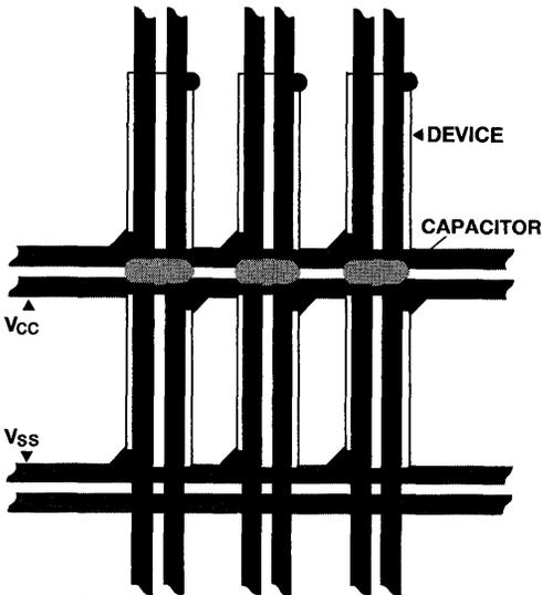
V<sub>CC</sub>, V<sub>SS</sub> GRID SHOWING
