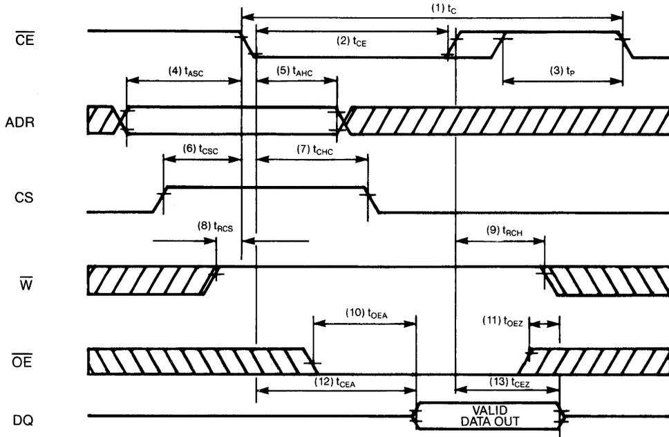
**EARLY-WRITE CYCLE ( $\overline{\text{OE}} \geq V_{\text{IH}}$ ,  $\overline{\text{RFSH}} \geq V_{\text{IH}}$ )**
