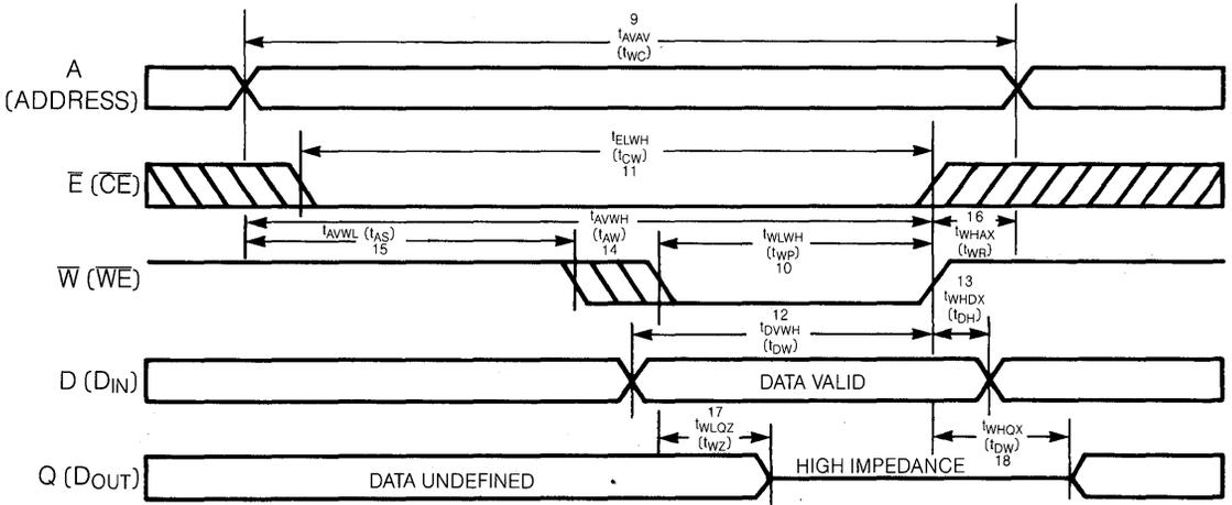
RECOMMENDED AC OPERATING CONDITIONS ( $0^{\circ}\text{C} \leq T_A \leq 70^{\circ}\text{C}$ ) ( $V_{CC} = 5.0\text{V} \pm 10\%$ )
