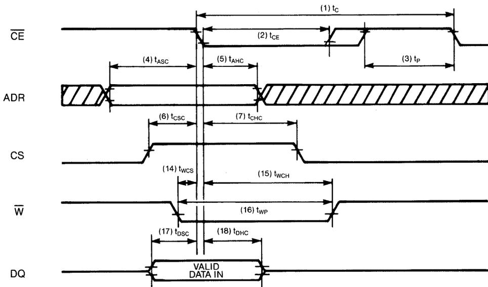
**LATE-WRITE CYCLE ( $\overline{OE} \geq V_{IH}$ ,  $\overline{RFSH} \geq V_{IH}$ )**
