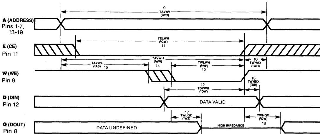
**RECOMMENDED AC OPERATING CONDITIONS** ( $0^{\circ}\text{C} \leq T_A \leq 70^{\circ}\text{C}$ ) ( $V_{CC} = 5.0\text{V} \pm 10\%$ )
