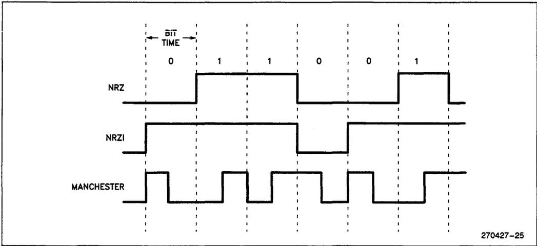
Figure 3.12. Transmit Waveforms
