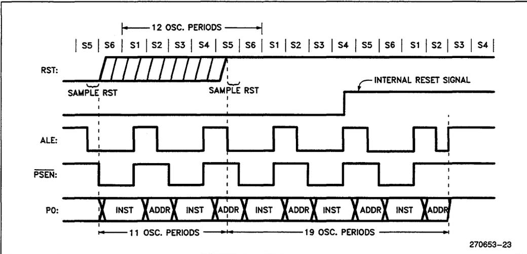
Figure 26. Reset Timing
