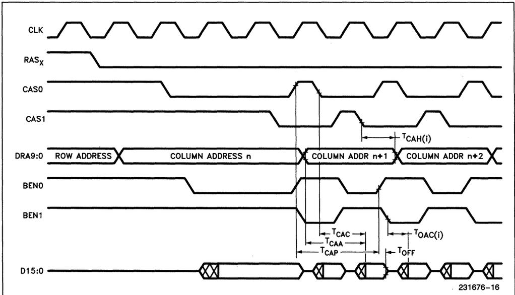
**DRAM SIGNALS—INTERLEAVED FAST PAGE MODE WRITE**
