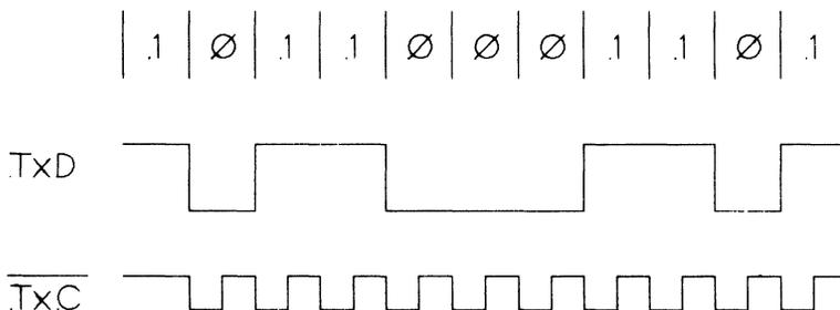
FIGURE 7.1 NRZ WAVEFORM RELATIVE TO  $\overline{\text{TxC}}$
