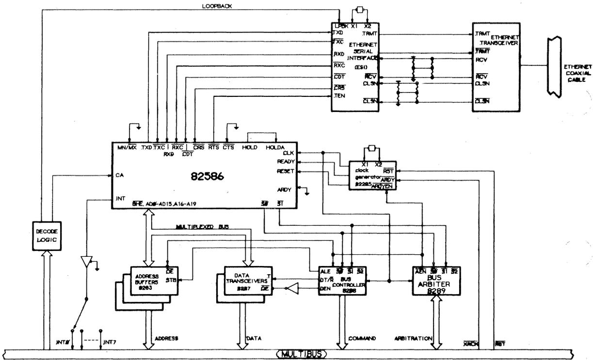
FIGURE 6.4 82586 STAND ALONE MULTIBUS® INTERFACE
