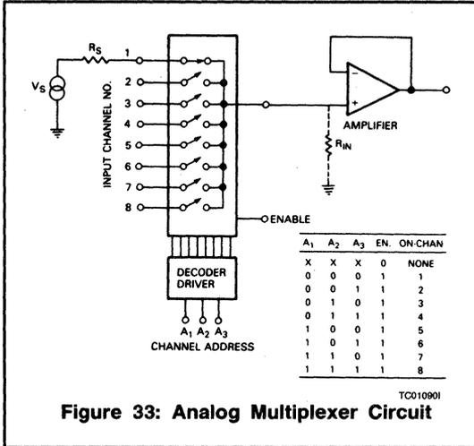
**Figure 33: Analog Multiplexer Circuit**
