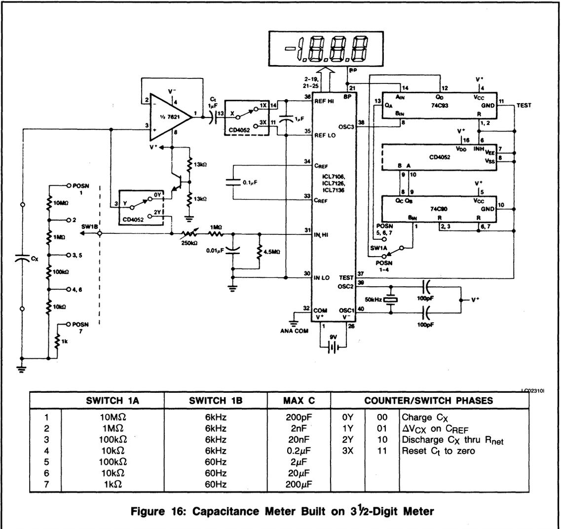
Figure 16: Capacitance Meter Built on 3 1/2-Digit Meter
