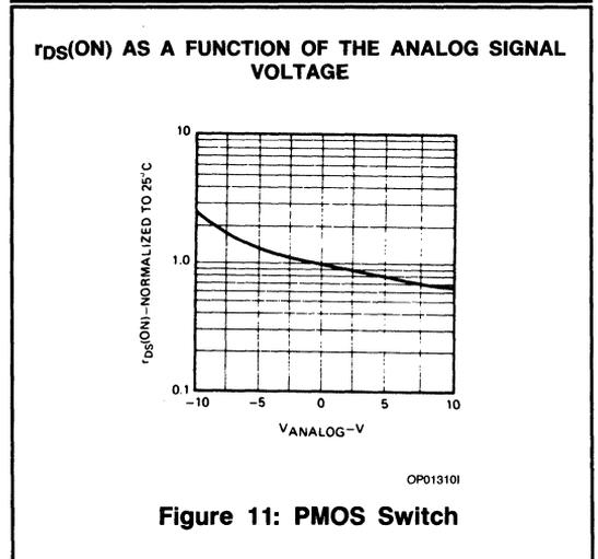
$r_{DS(ON)}$  AS A FUNCTION OF THE ANALOG SIGNAL VOLTAGE
