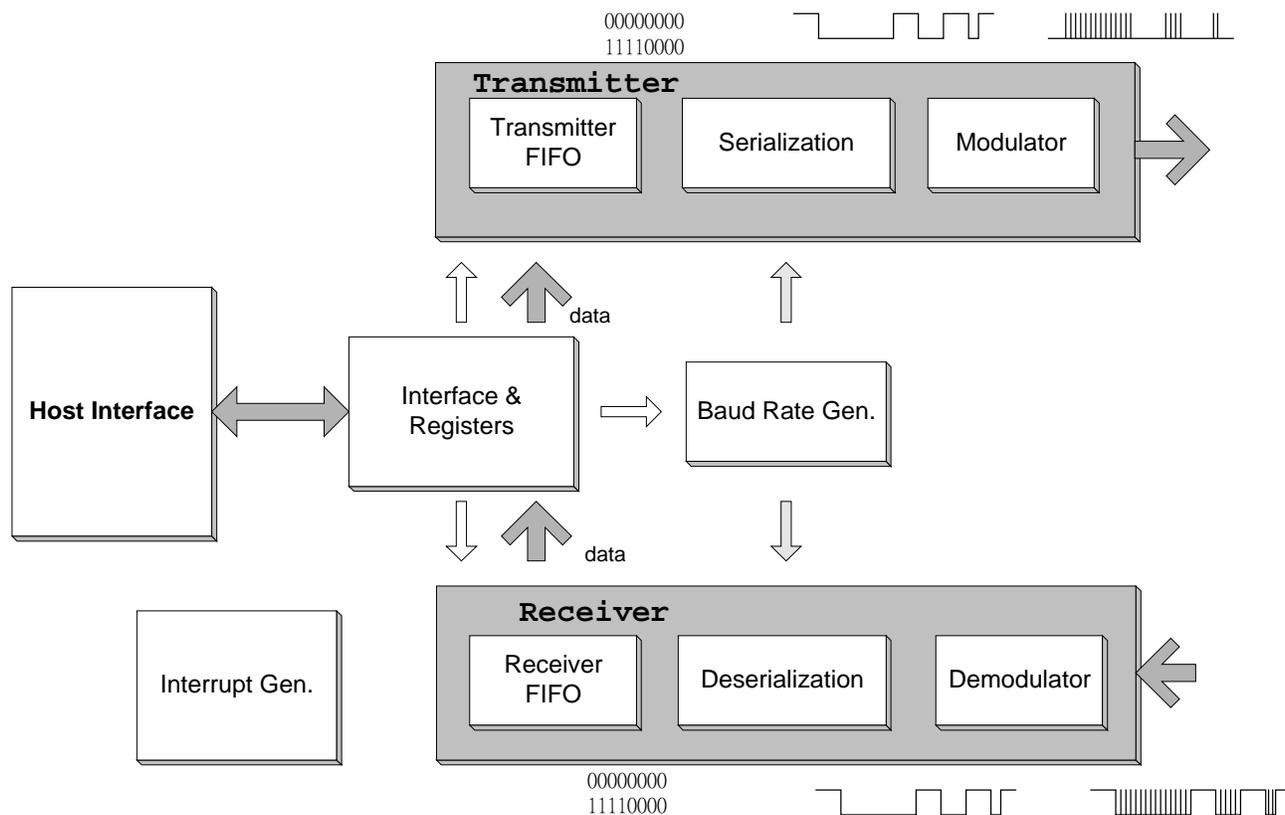
**Figure 9-7. CIR Block Diagram**
