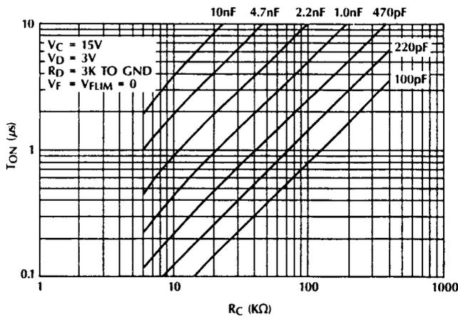
Figure 2b.  $T_{ON}$  vs.  $R(C)$
