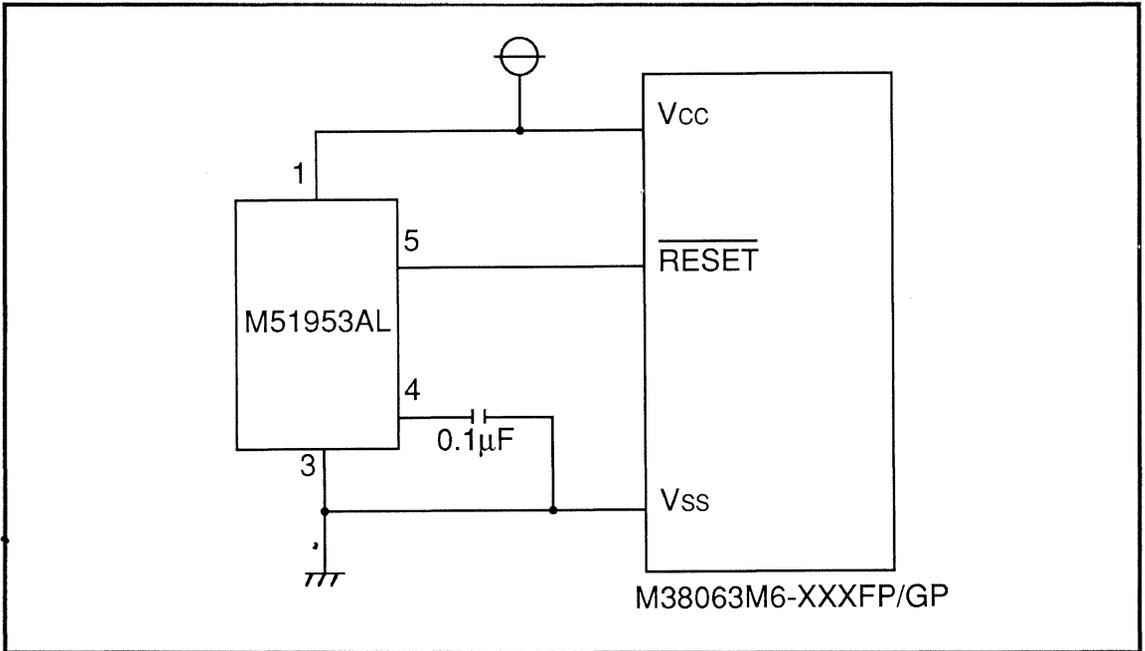
Fig. 2.11.4 Power-on Reset Circuit Example
