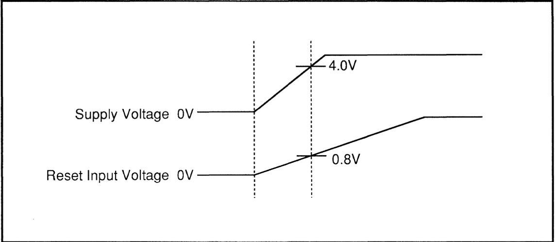
Fig. 2.11.3 Power-on Reset Condition
