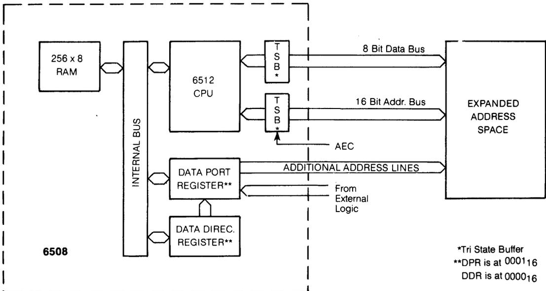
**MPS 6508 — EXPANDED MEMORY CONFIGURATION**
