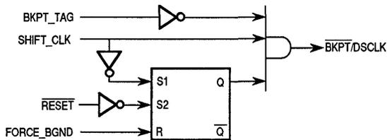
**Figure 7-9.  $\overline{\text{BKPT/DSCLK}}$  Logic Diagram**
