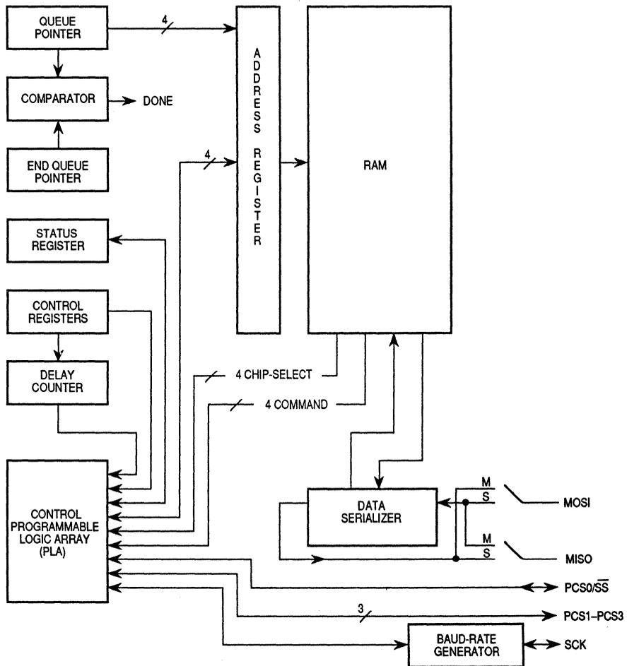
Figure 4-1. QSPI Submodule Diagram
