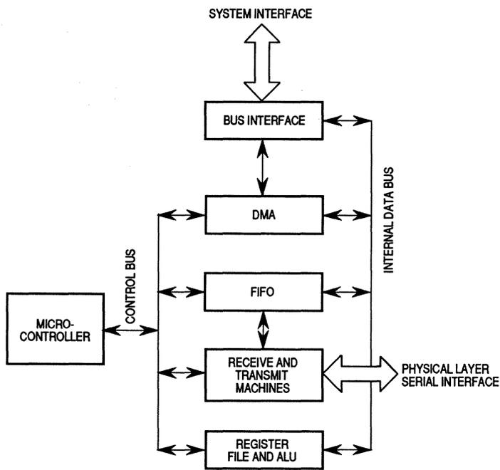
Figure 1-2. MC68605 Block Diagram
