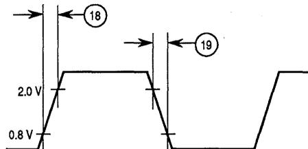
Figure 5-4. Output TTL Edge Timing
