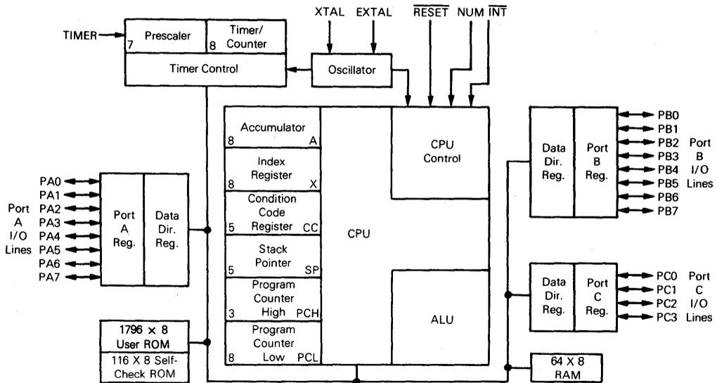
Figure 1-3. MC6805P6 Block Diagram
