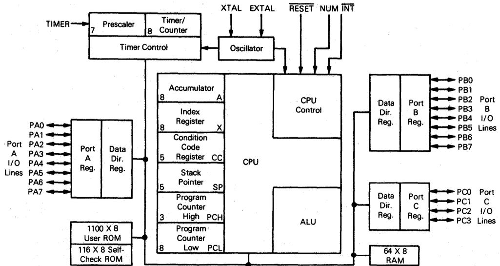
Figure 1-1. MC6805P2 Block Diagram
