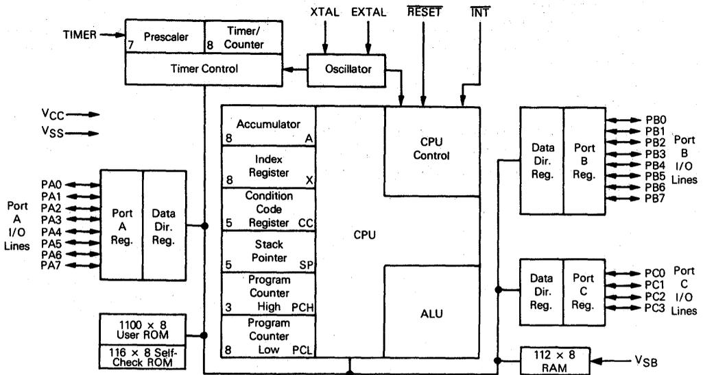
Figure 1-2. MC6805P4 Block Diagram
