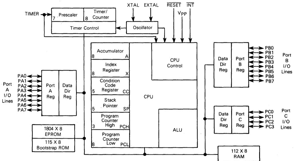
Figure 1-4. MC68705P3 Block Diagram
