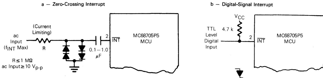
FIGURE 15 — TYPICAL PORT I/O CIRCUITRY
