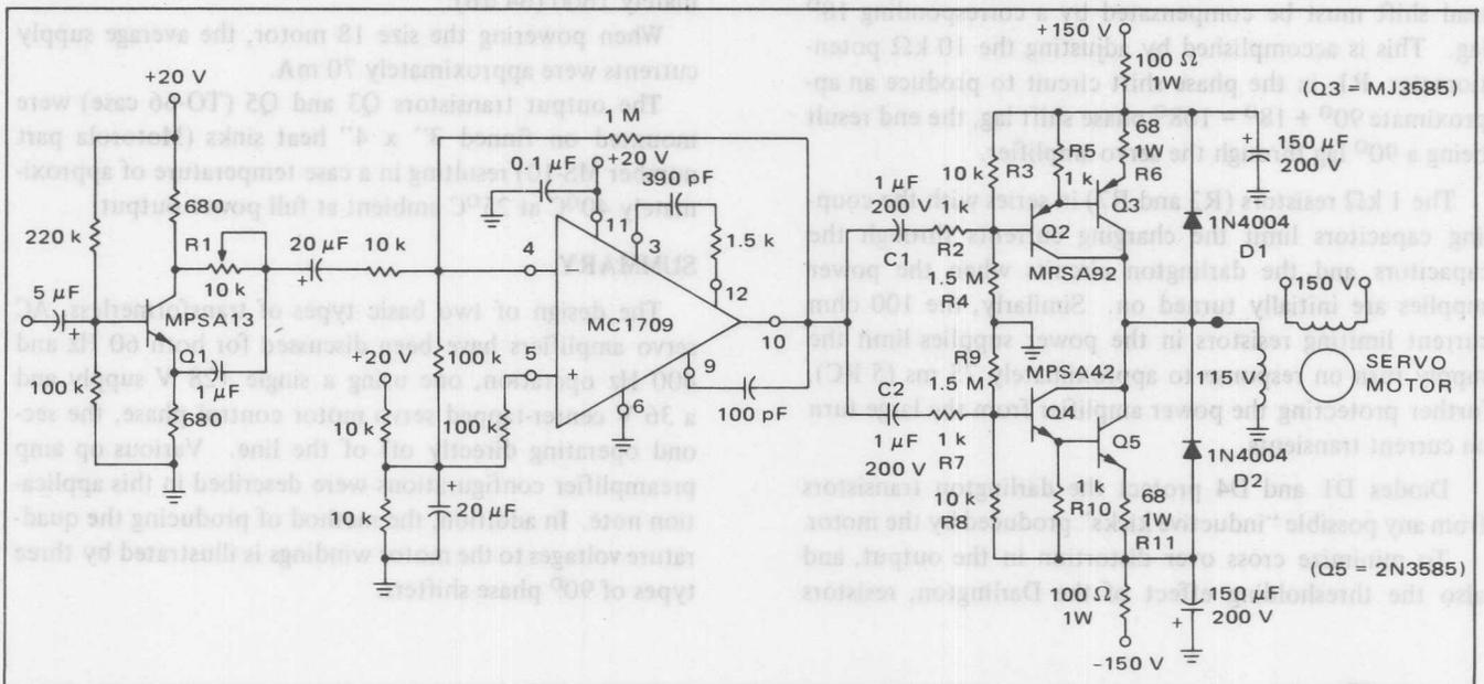
FIGURE 9 — LINE OPERATED SERVO AMPLIFIER
