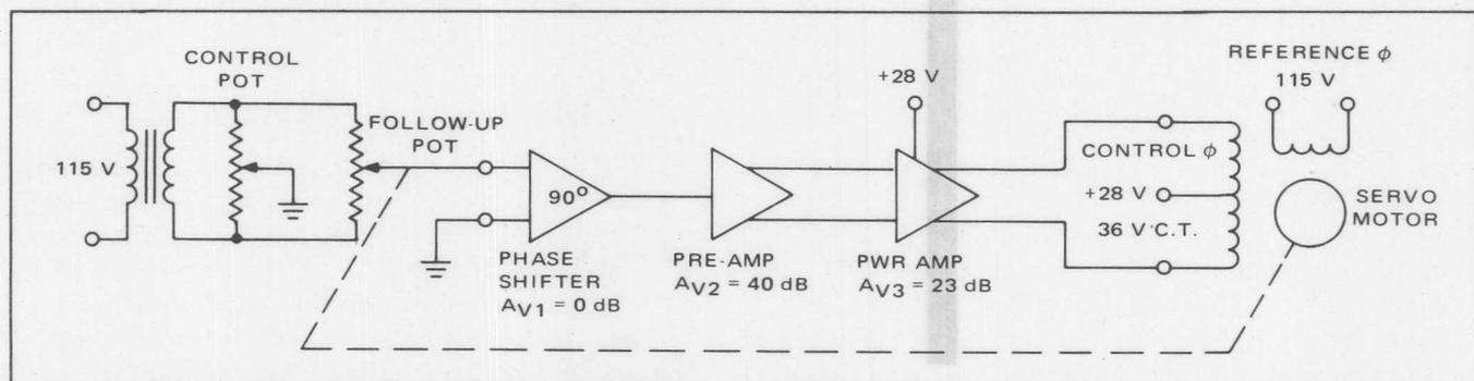
FIGURE 1 - SERVO AMPLIFIER BLOCK DIAGRAM
