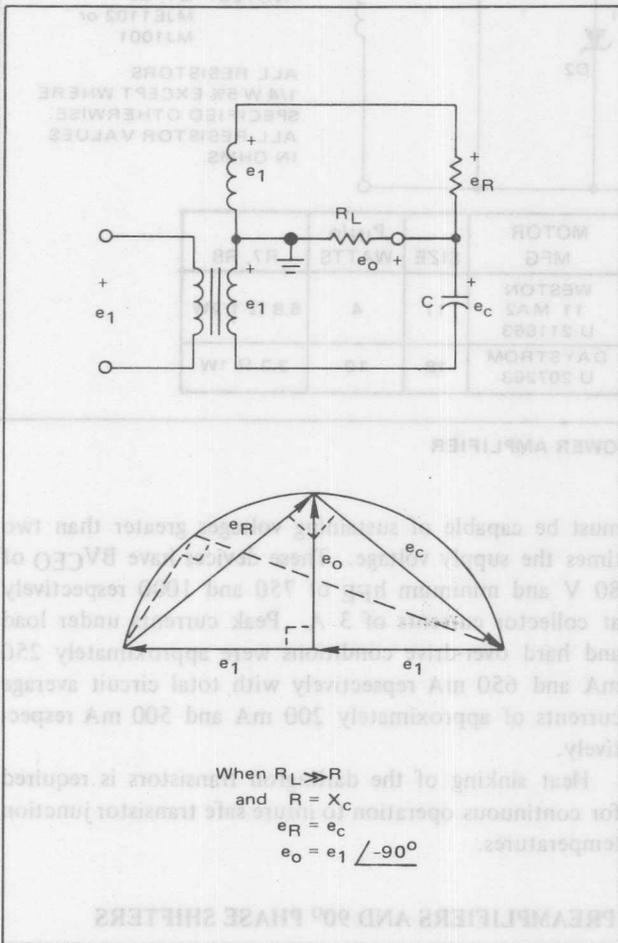
FIGURE 3 – PUSH-PULL RC PHASE SHIFTER
