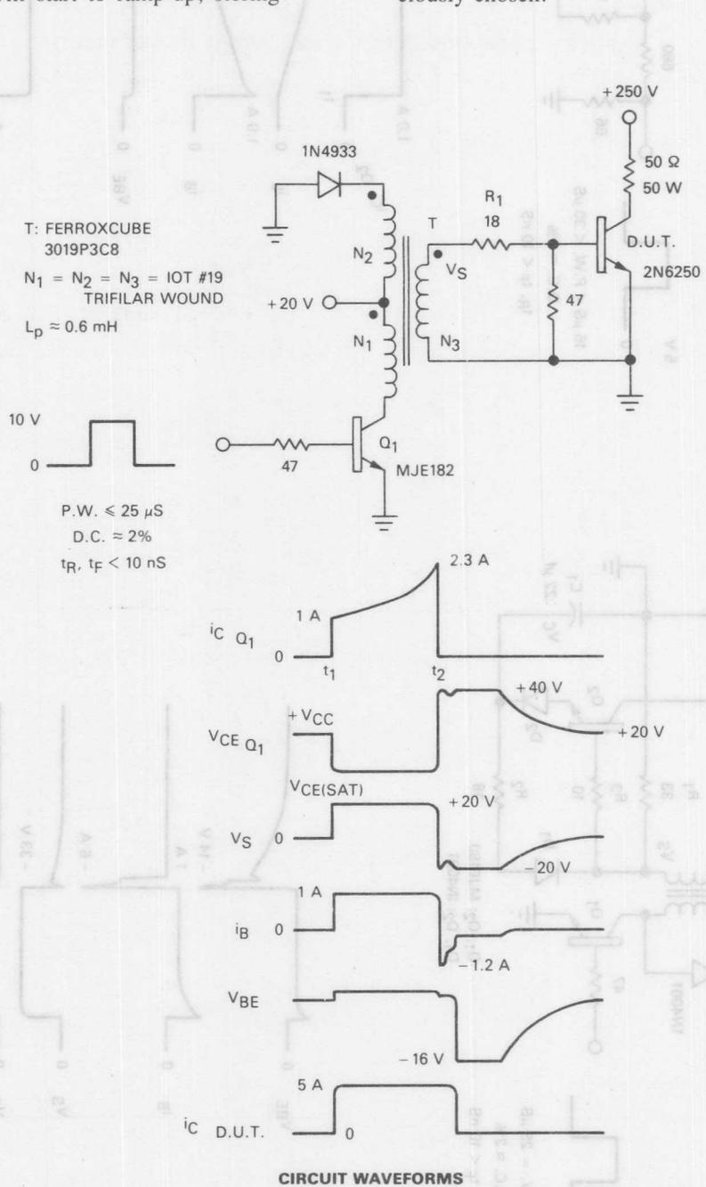
FIGURE 14 — SINGLE-ENDED, PUSH-PULL E-B AVALANCHE DRIVE CIRCUIT
