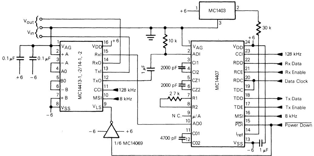
FIGURE 8 — TYPICAL CIRCUIT CONFIGURATION
