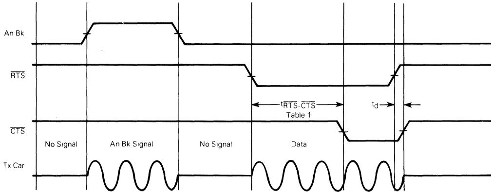
TABLE 1 —  $\overline{\text{RTS}}\text{-}\overline{\text{CTS}}$  DELAY TIMES
