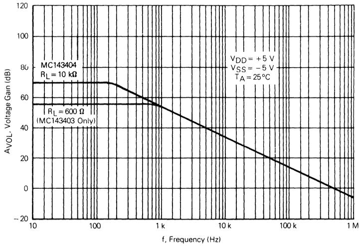
FIGURE 2 — TYPICAL POWER BANDWIDTH
