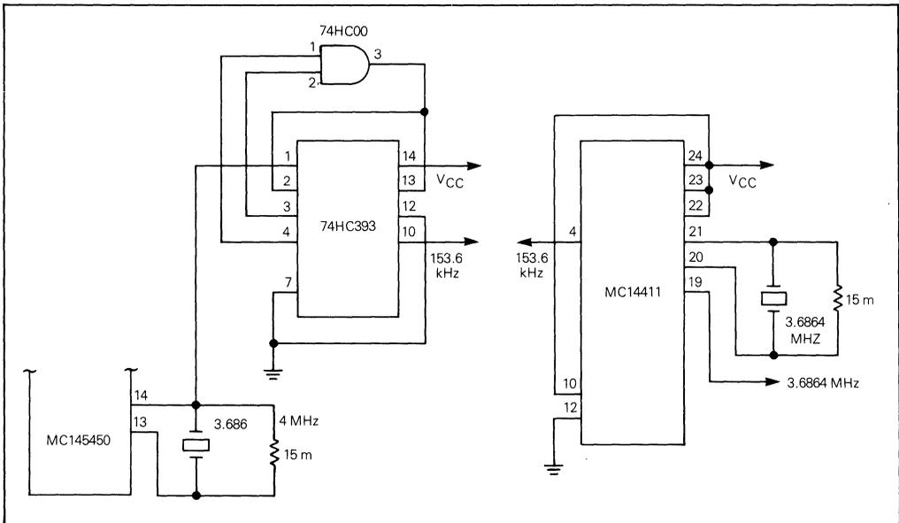
FIGURE 3 — CLOCK CIRCUITS
