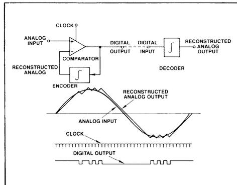
**FIGURE 1 — SIMPLE DELTA MODULATION**
