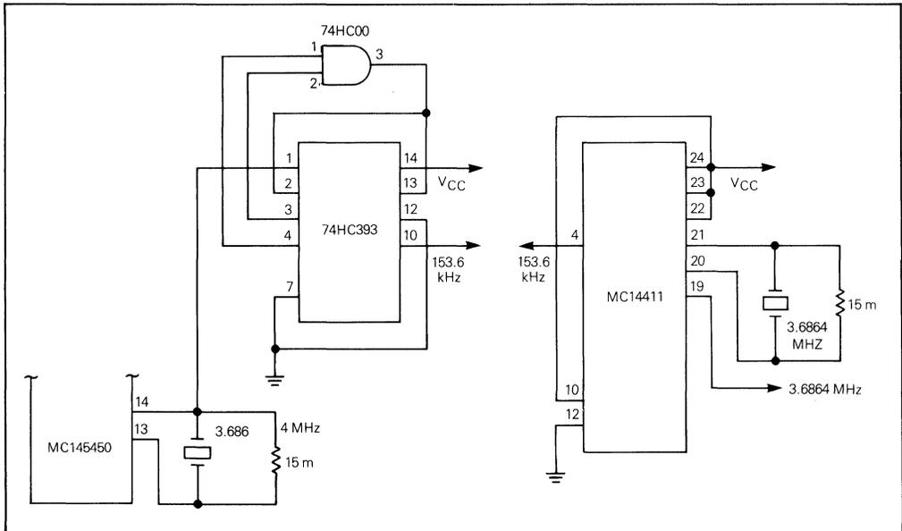
FIGURE 3 — CLOCK CIRCUITS
