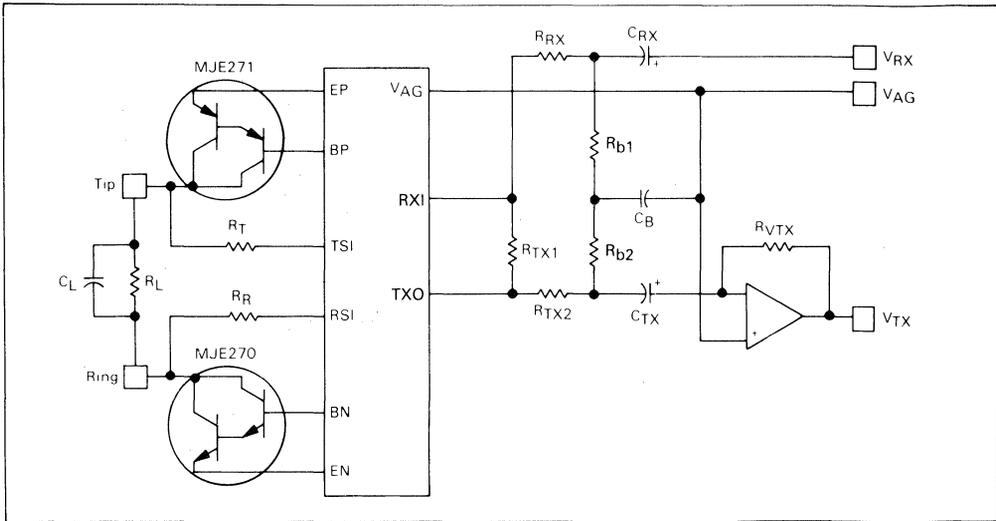
FIGURE 13 — BALANCE NETWORK FOR COMPLEX LOAD IMPEDANCES
