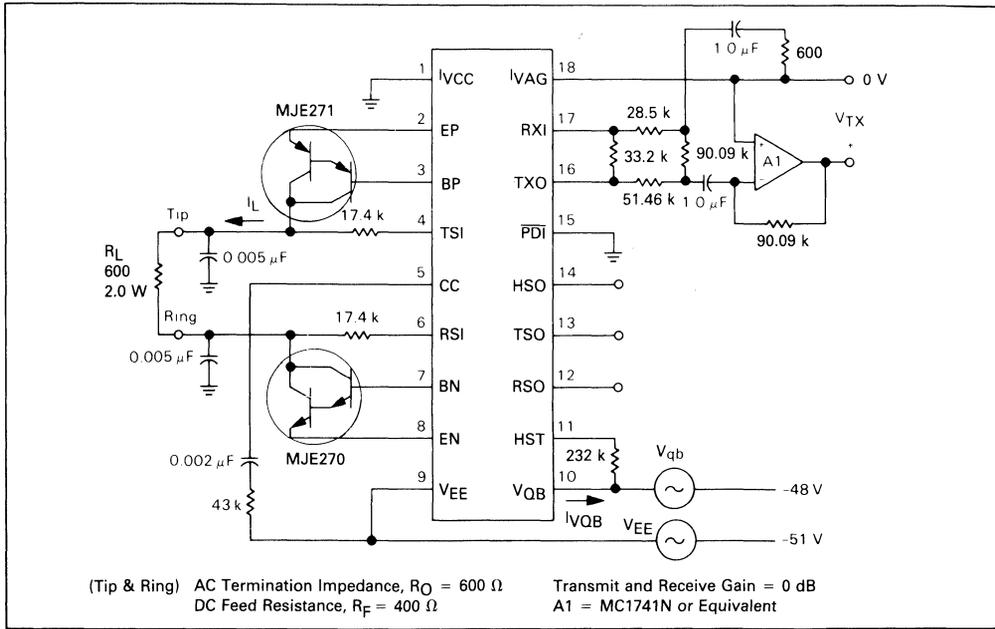
FIGURE 4 — TSO AND RSO SUPERVISORY OUTPUT TEST CIRCUIT
