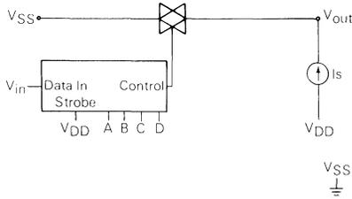
FIGURE 2 – PROPAGATION DELAY TIME
