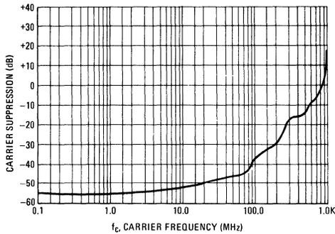
FIGURE 7 — CARRIER SUPPRESSION VERSUS FREQUENCY (Test 2)
