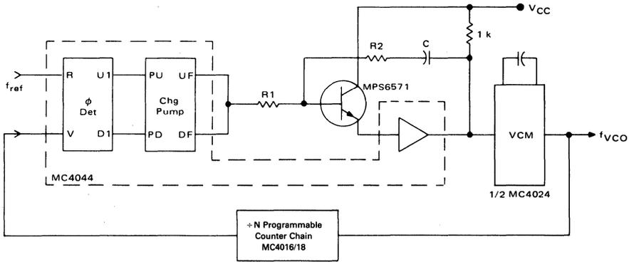
FIGURE 5 — M TTL-MECL PHASE-LOCKED LOOP
