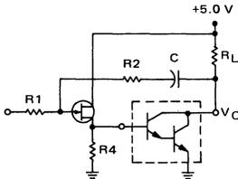
FIGURE 14 — EMITTER FOLLOWER BUFFERING OF AMPLIFIER INPUT
