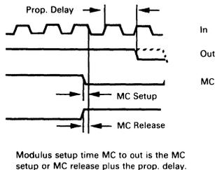
FIGURE 2 — TYPICAL OUTPUT WAVEFORM
