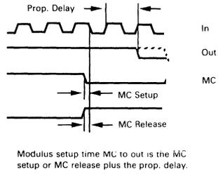
FIGURE 2 — TYPICAL OUTPUT WAVEFORMS
