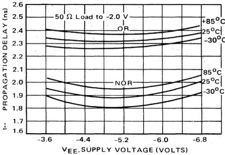
FIGURE 10b — TYPICAL PROPAGATION DELAY  $t_{++}$  versus  $V_{EE}$  AND TEMPERATURE (MECL 10K)
