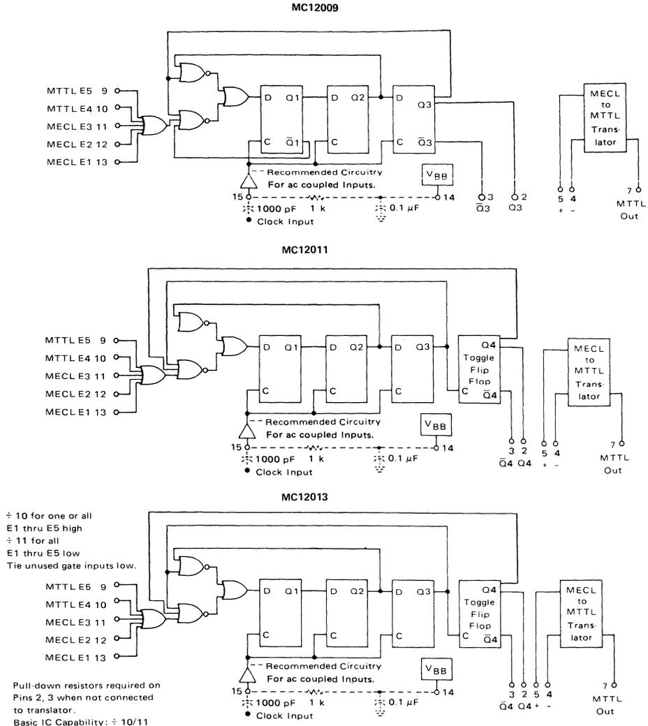
FIGURE 2 – TYPICAL FREQUENCY SYNTHESIZER APPLICATION
