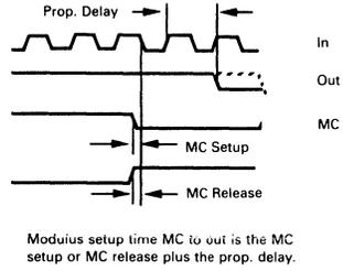
FIGURE 2 — TYPICAL OUTPUT WAVEFORMS
