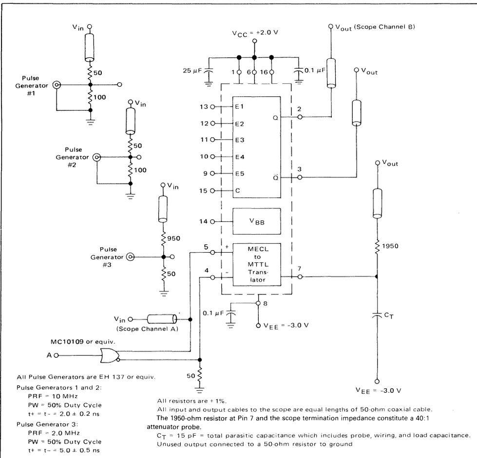
FIGURE 6 – MAXIMUM FREQUENCY TEST CIRCUIT
