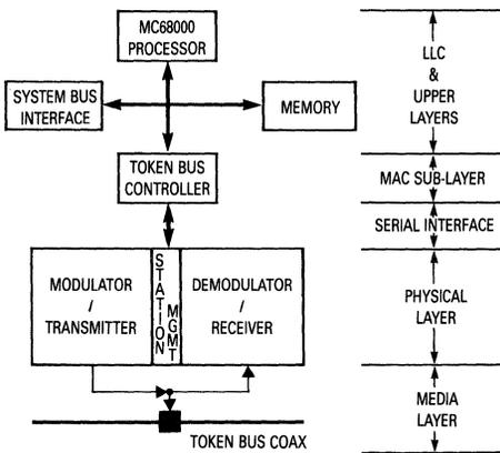
Figure 1-1. IEEE 802.4 Token Bus Carrier Band Node
