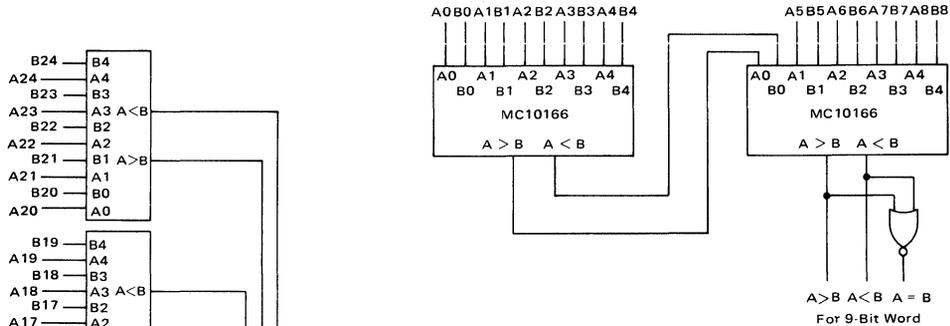
FIGURE 2 — 25-BIT MAGNITUDE COMPARATOR
