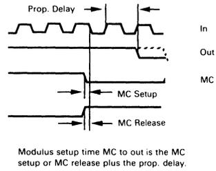
FIGURE 2 — TYPICAL OUTPUT WAVEFORMS
