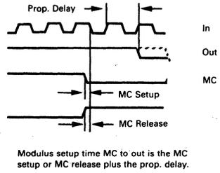
FIGURE 2 — TYPICAL OUTPUT WAVEFORMS
