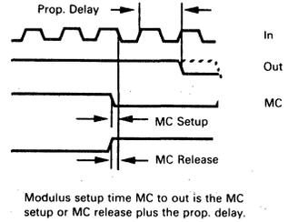
FIGURE 2 — TYPICAL OUTPUT WAVEFORMS
