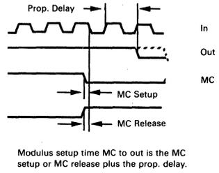
FIGURE 2 — TYPICAL OUTPUT WAVEFORMS
