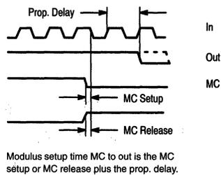
FIGURE 2 — TYPICAL OUTPUT WAVEFORMS
