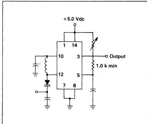
FIGURE 12 — CIRCUIT USED FOR COLLECTOR OUTPUT OPERATION
