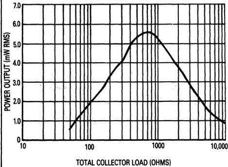
FIGURE 14 — POWER OUTPUT versus COLLECTOR LOAD
