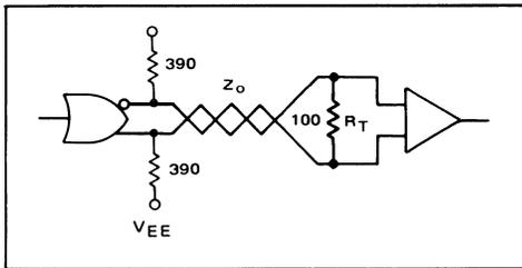
FIGURE 26 — PARALLEL FANOUT TECHNIQUES
