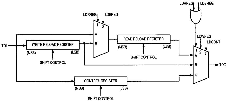
THE LEFT MOST CONTROL SIGNAL ENTERING THE MUX FROM THE TOP(1) SELECTS THE UPPER MOST INPUT ON THE LEFT SIDE OF THE MUX(A). THE RIGHT MOST CONTROL SIGNAL SELECTS THE BOTTOM MOST INPUT.
