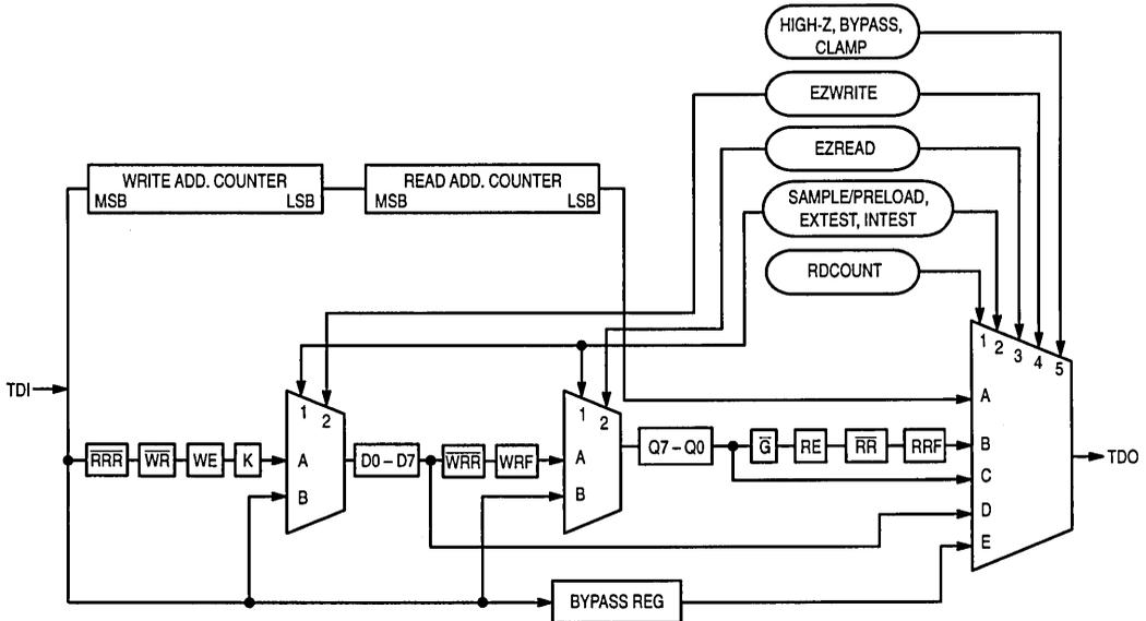
THE LEFT MOST CONTROL SIGNAL ENTERING THE MUX FROM THE TOP(1) SELECTS THE UPPER MOST INPUT ON THE LEFT SIDE OF THE MUX(A). THE RIGHT MOST CONTROL SIGNAL SELECTS THE BOTTOM MOST INPUT.
