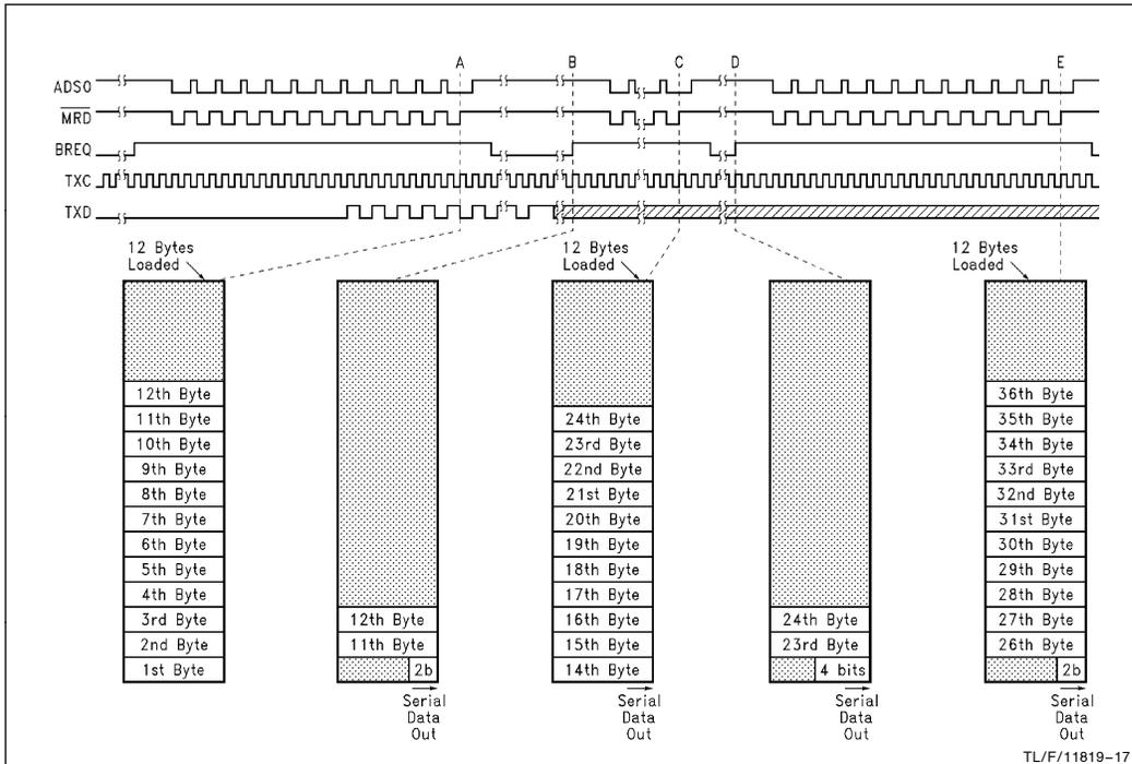
**FIGURE 17. Transmit Packet—Byte Mode, 12 Byte Threshold**
