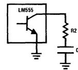
FIGURE 10. Discharge Circuit
