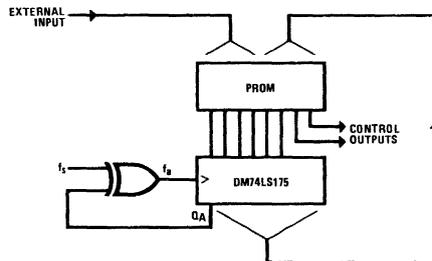
TOGGLING  $Q_A$  AT ADDRESS  $N$  ALLOWS OPERATION ON CLOCK EDGE  $N + \frac{1}{2}$
