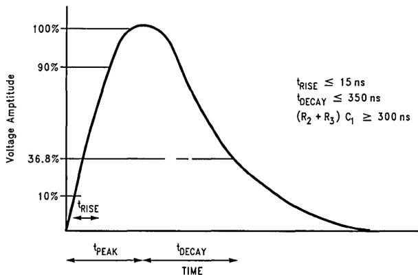
**FIGURE 24. ESD Pulse Waveform**
