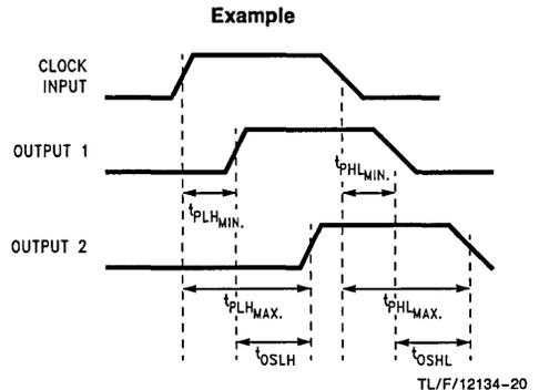
**FIGURE 20.  $t_{OSLH}$ ,  $t_{OSHL}$**
