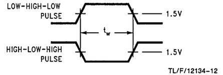
**FIGURE 12. Pulse Width**
