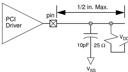
Figure 6-4. PCI Falling Edge ( $t_{HL}$ ) Test Circuit
