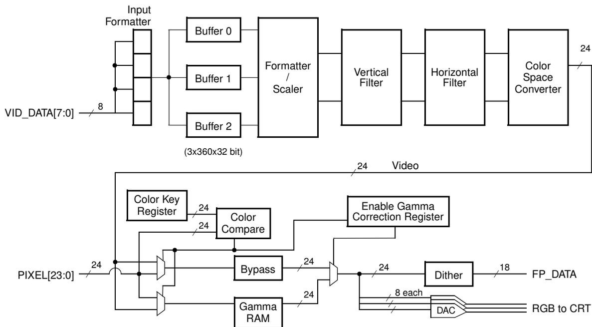
**Figure 4-23. 8-Bit Display Subsystem Extensions**
