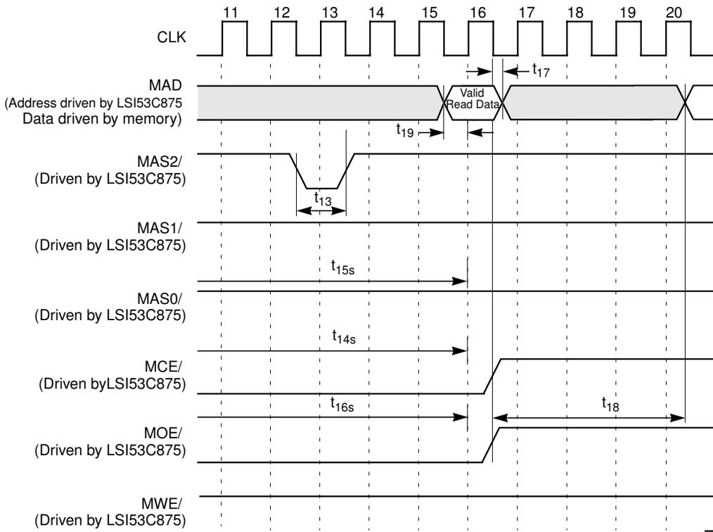
**Figure 7.26 Write Cycle, Slow Memory ( $\geq 64$  Kbyte)**
