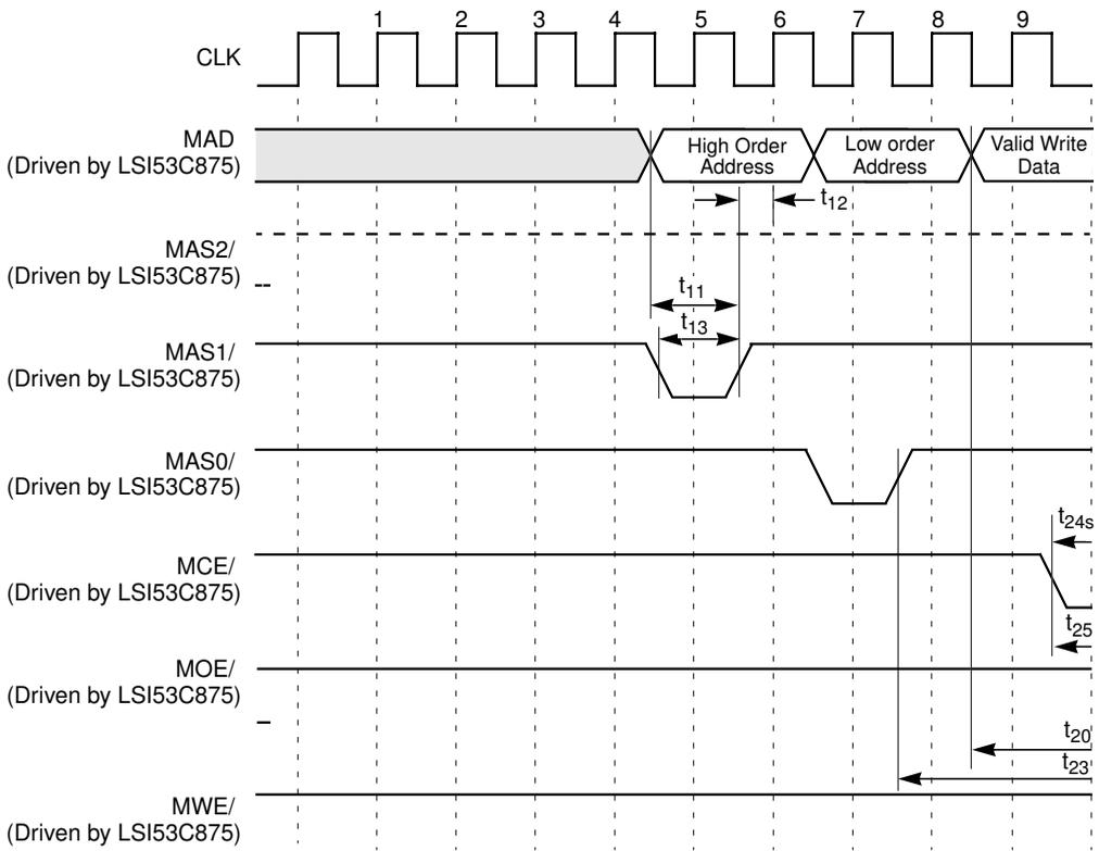
**Figure 7.30 Write Cycle, Slow Memory ( $\leq 64$  Kbyte) (Cont.)**
