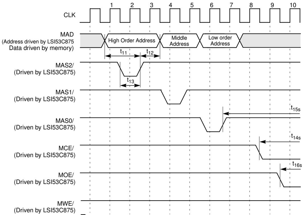
**Figure 7.25 Read Cycle, Slow Memory ( $\geq 64$  Kbyte) (Cont.)**
