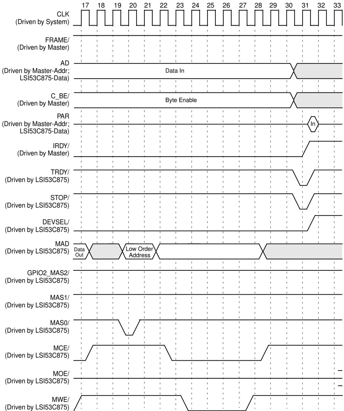
**Figure 7.25 Read Cycle, Slow Memory ( $\geq 64$  Kbyte)**
