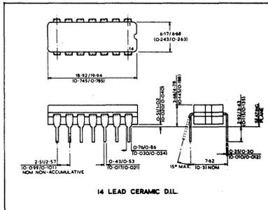
**SP721B** BALANCED LINE DRIVER **SP722B** BALANCED LINE RECEIVER
