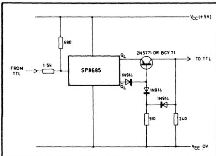
Fig. 5 TTL o/p – SP8685  $\overline{PE}$  i/p; SL8685 o/p – TTL i/p.
