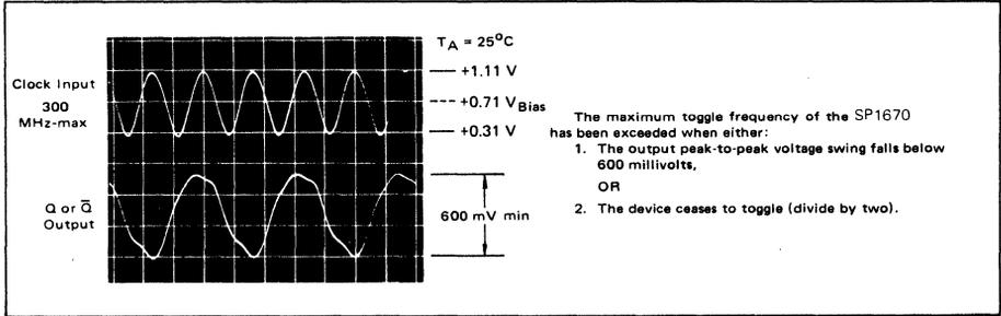
FIGURE 6 – MAXIMUM TOGGLE FREQUENCY (TYPICAL)
