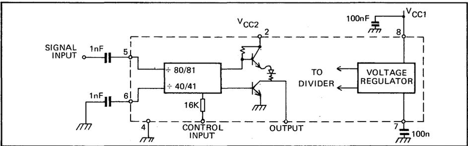
Fig. 2 — Block Diagram
