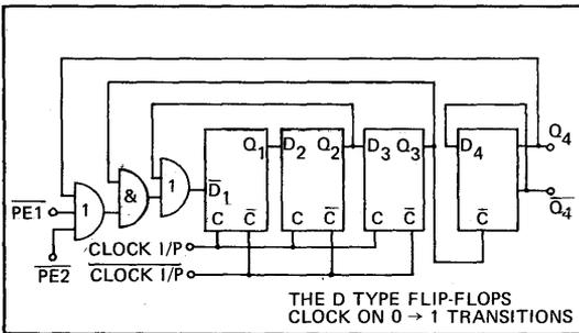
Fig. 2 LOGIC DIAGRAM (+VE LOGIC)
