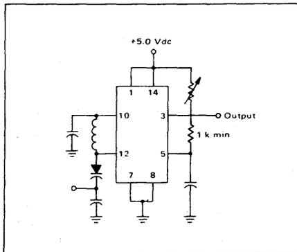
FIGURE 12 – CIRCUIT SCHEMATIC USED FOR COLLECTOR OUTPUT OPERATION
