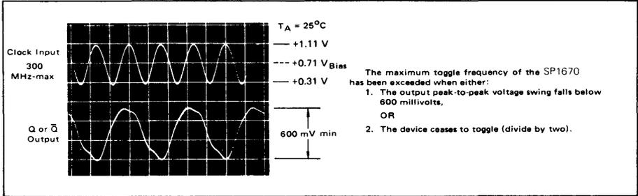
FIGURE 6 – MAXIMUM TOGGLE FREQUENCY (TYPICAL)
