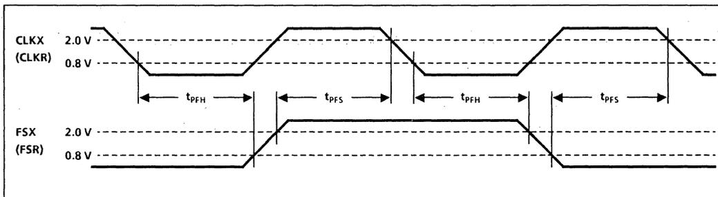
Fig. 24 Timing - PCM frame synchronisation
