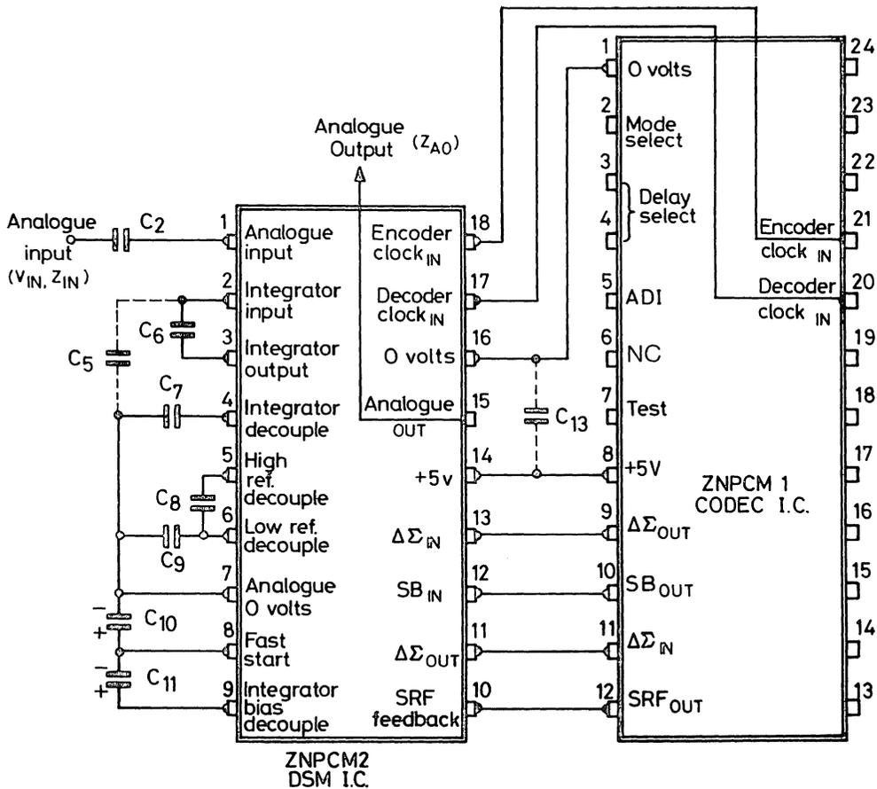
Fig. 4. DSM-Codec Interface
