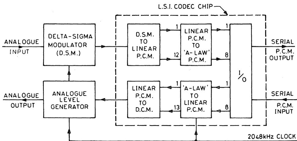
Fig. 1. Codec Schematic
