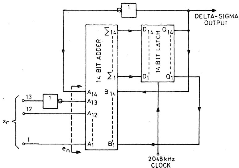
Fig. 10. Digital DSM Circuit Realisation
