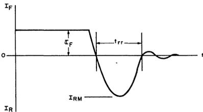
OSCILLOSCOPE DISPLAY OF REVERSE-RECOVERY TIME
