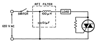
Fig. 20— RFI-suppression filter.
