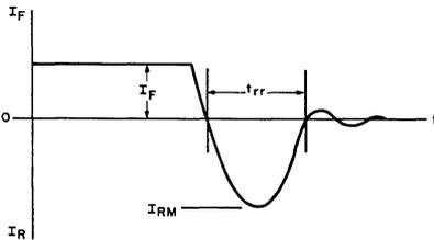
OSCILLOSCOPE DISPLAY OF REVERSE-RECOVERY TIME
