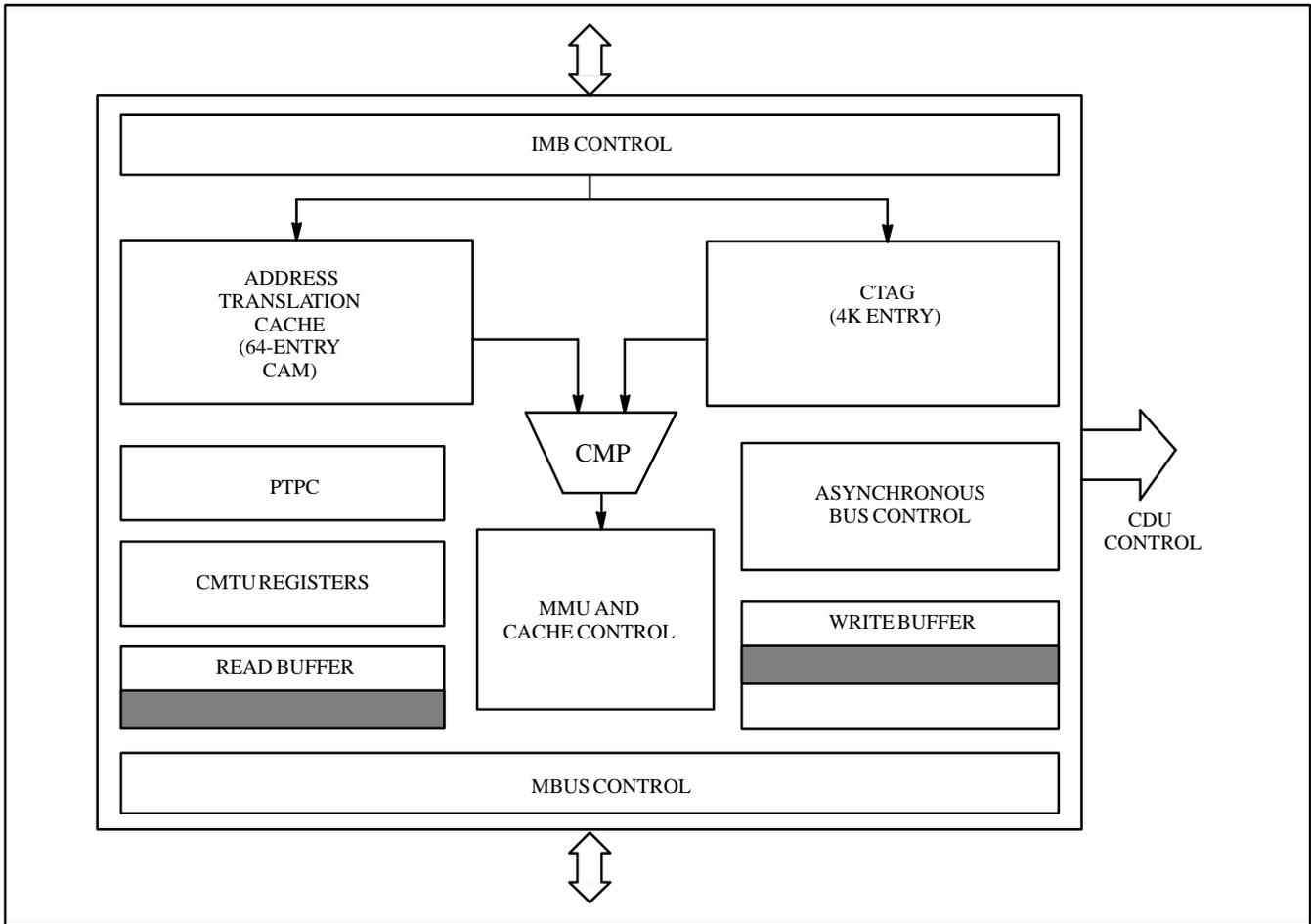
**Figure 3. CMTU Block Diagram (RT625)**
