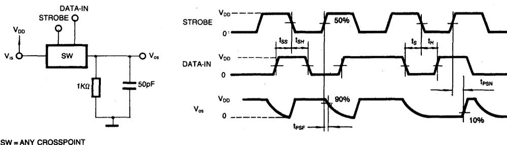
FIG. 6. PROPAGATION DELAY TIME & WAVE FORMS (DATA-IN SIGNAL OUTPUT, SWITCH TURN ON TO HIGH OR LOW LEVEL)
