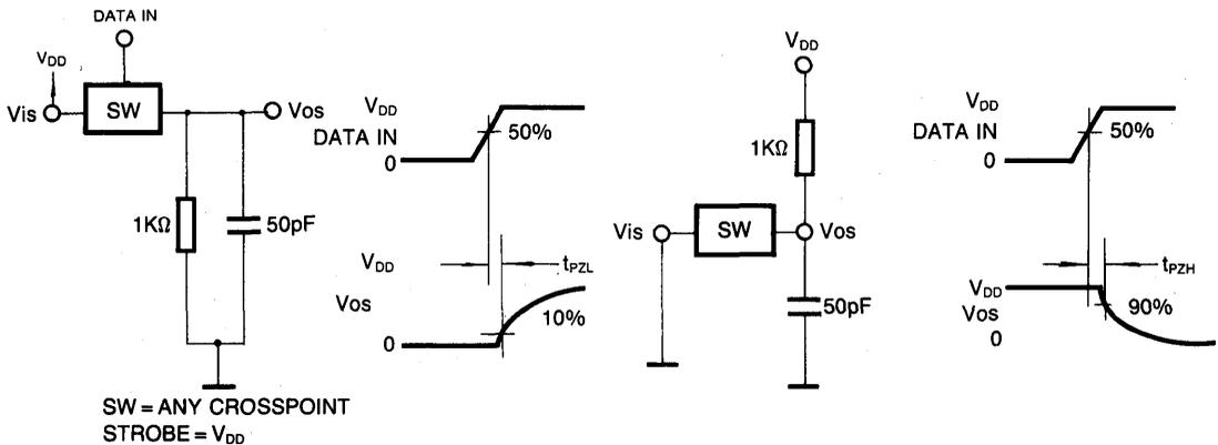
FIG. 7 PROPAGATION DELAY TIME & WAVEFORMS
