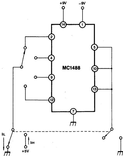
FIGURE 2 OUTPUT VOLTAGE
