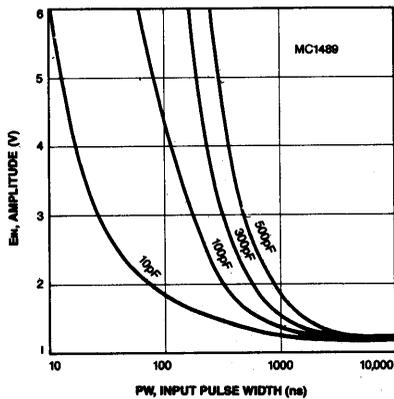
Fig. 4 — TYPICAL TURN-ON THRESHOLD  $V_o$  CAPACITANCE FROM RESPONSE CONTROL PIN TO GND
