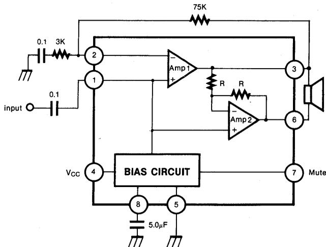
Fig. 2 DUAL SUPPLY OPERATION
