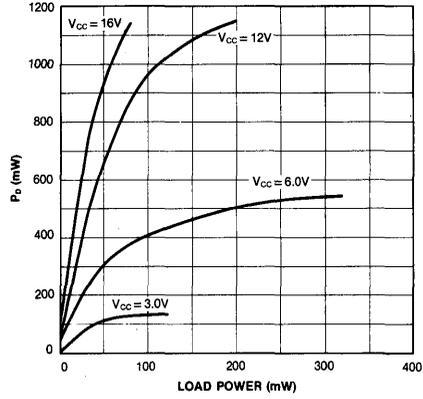
Fig. 19 POWER DISSIPATION (32Ω LOAD)
