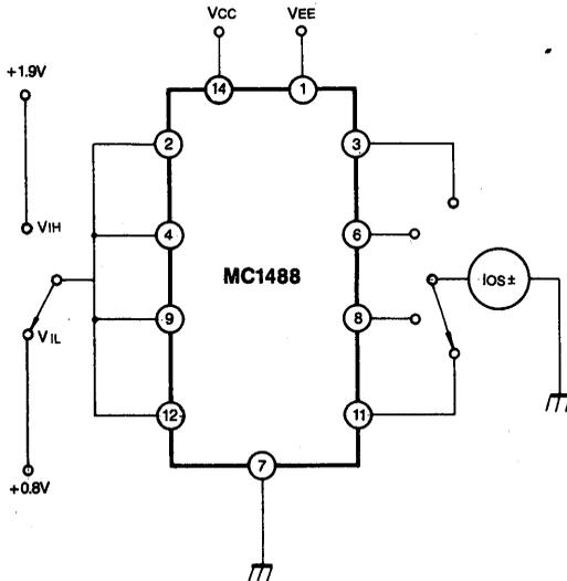
FIGURE 4 OUTPUT RESISTANCE (POWER OFF)
