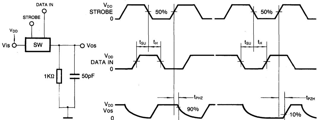
FIG. 6 PROPAGATION DELAY TIME & WAVEFORMS
