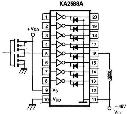
TELECOMMUNICATION RELAY DRIVER (POSITIVE LOGIC)
