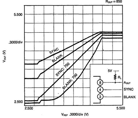
**HIGH SPEED TRIPPLE D/A
