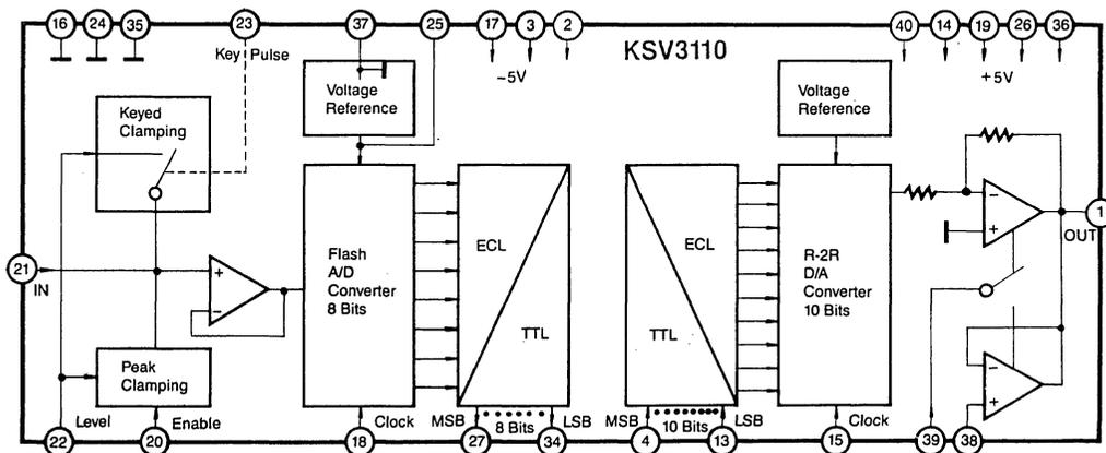
Fig. 3 KSV3110 Block Diagram
